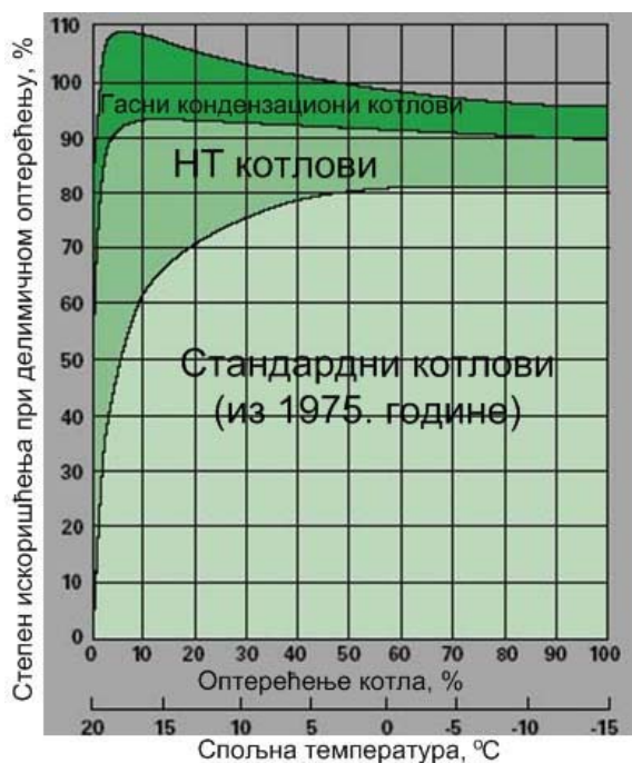
Slika 4. Dijagram zavisnosti stepena iskorišćenja od opterećenju kotla za tri različite vrste kotlova
