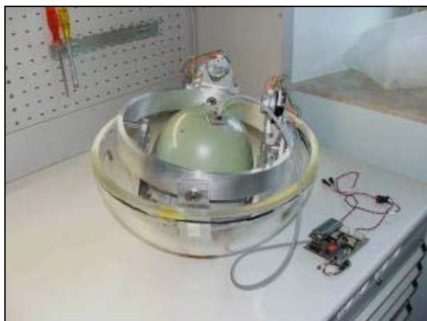
Figura 16. Prototipo della base autolivellante per gli OBS/H.
