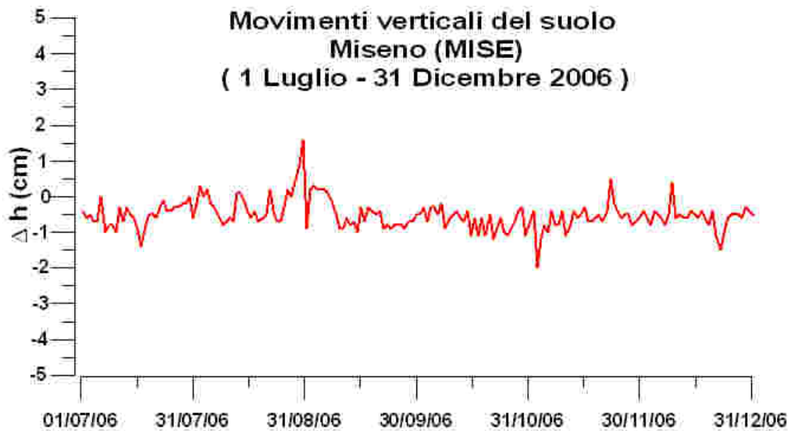
Figura 15. Movimenti verticali del suolo, nel periodo luglio - dicembre 2006, ottenuti dall'analisi dei dati acquisiti dal sensore digitale della stazione mareografica di Miseno (MISE) e riferiti a quella del porto di Napoli.
