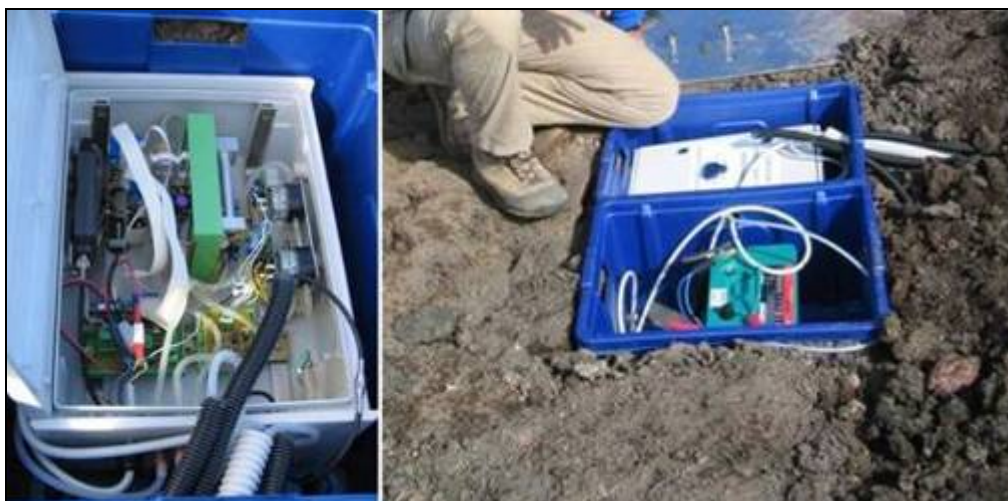
Figura 1. La stazione in continuo installata sul cratere sommitale di Stromboli.
