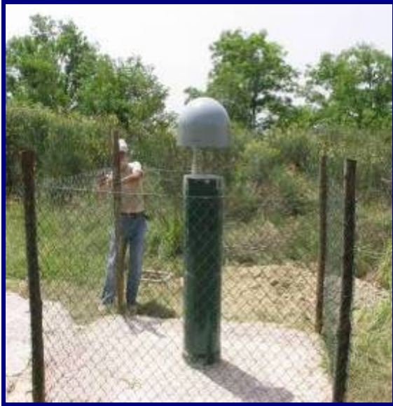
Fig. 14. Due delle fasi principali di installazione della stazione permanente GPS di Pesaro (giugno 2006) con trasmissione del segnale mediante linea etHernet e collegamento RUPA.
