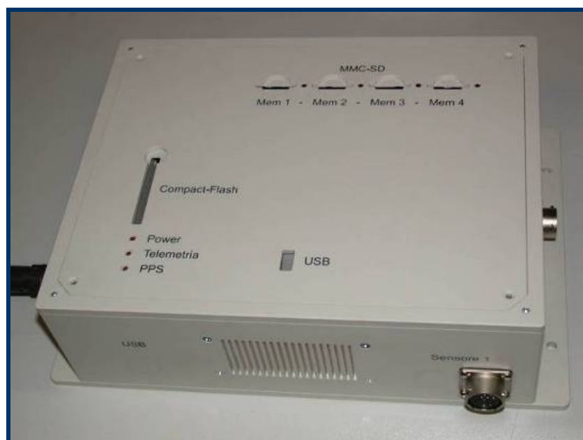
Figura 8. Una stazione sismica GAIA-2 nell'alloggiamento utilizzato per installazioni permanenti. Si nota il pannello esterno superiore, con i led per verificarne il funzionamento e gli alloggiamenti per le memorie di vario tipo. Sui lati esterni i connettori per l'alimentazione, per i sensori e i collegamenti in rete.
