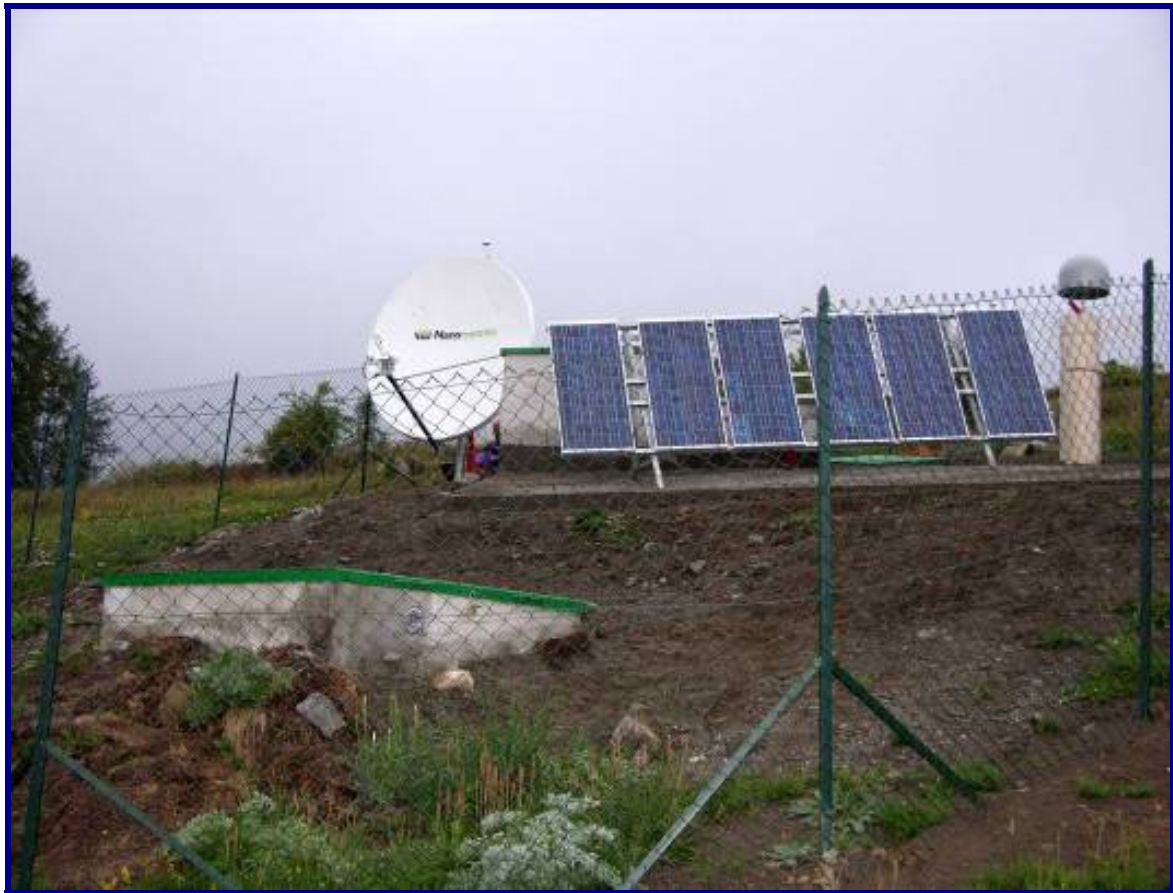
Fig. 13. Stazione integrata sismica e GPS con trasmissione satellitare Nanometrics. Si nota l'antenna GPS sulla destra, i pannelli solari per l'alimentazione dell'intera stazione, la parabola per la trasmissione dati a sinistra, il pozzetto per il sismometro in basso a sinistra.
