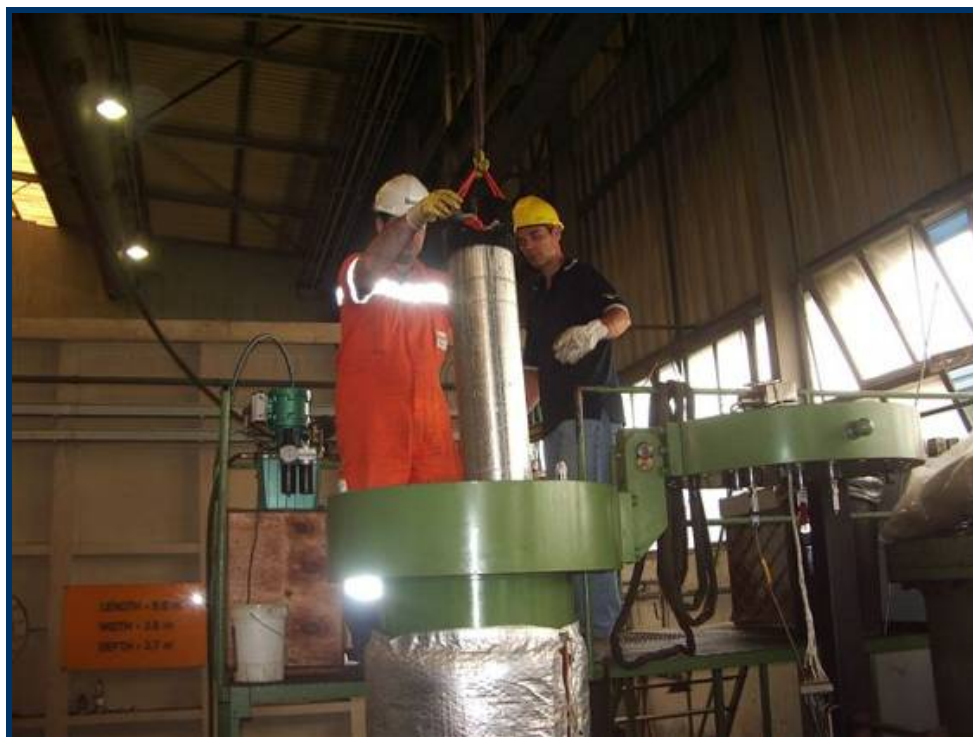
Figura 9. Prove di funzionamento in Pressione dello strumento OBS/H costruito nei laboratori dell'Osservatorio di Gibilmanna del CNT.
