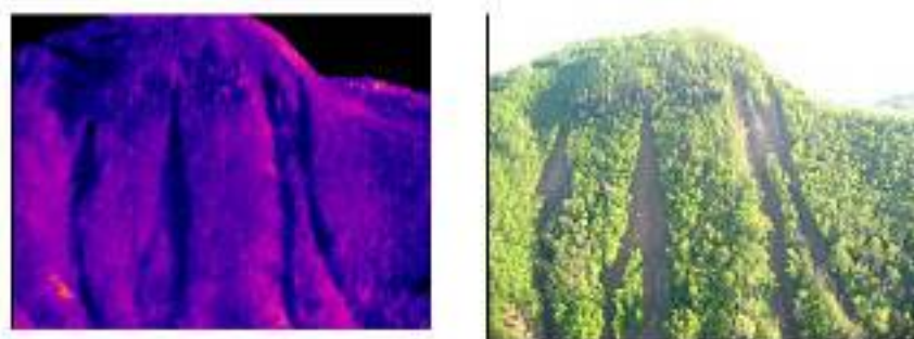
Figura 130. Immagine termica (a sinistra) e nel visibile (a destra) del versante interessato dalle frane.
