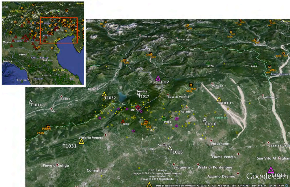
Figura 1. Geometria della Rete sismica mobile INGV. I triangoli gialli rappresentano le stazioni da trasmettere in real-time tramite sistema UMTS, quelli fucsia le stand-alone . I triangoli bianchi sono le ulteriori 4 stazioni temporanee che verranno installate dalle prime ore del 15 settembre.
