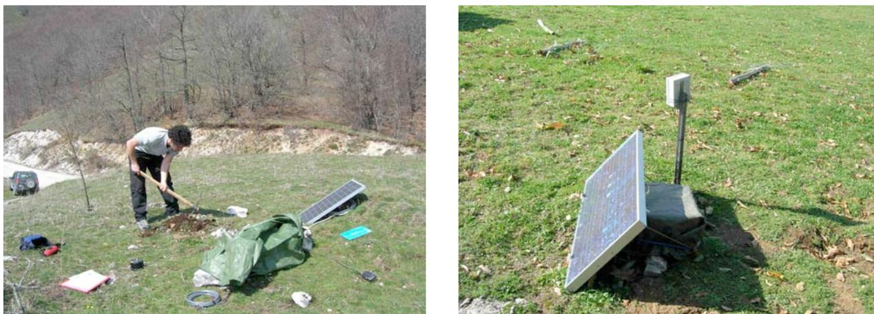
**Figura 2.** Installazione della stazione RM29 e sua configurazione in trasmissione UMTS.
