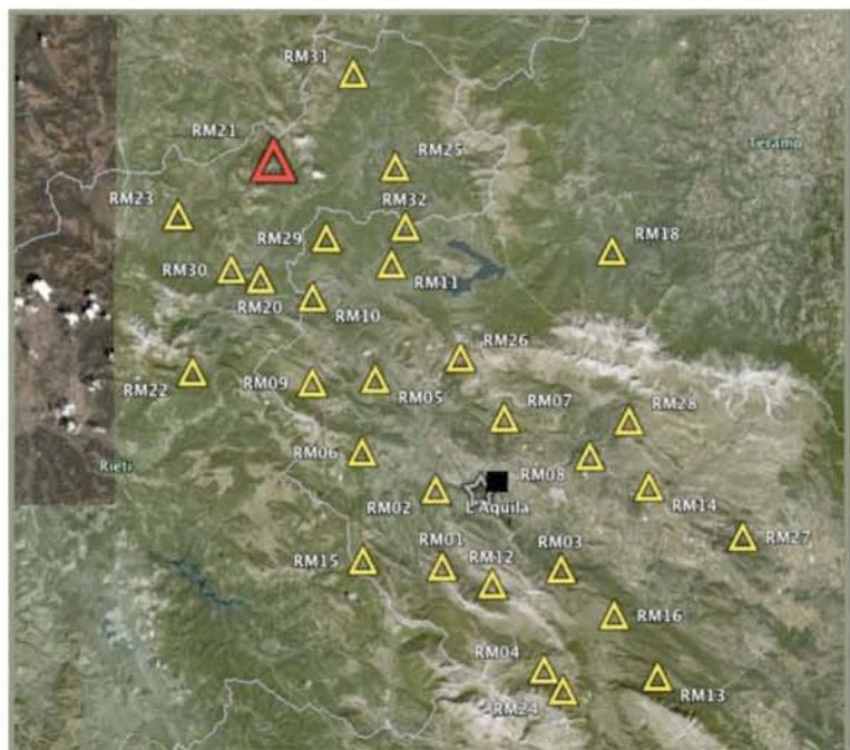
RM21 è stata inizialmente installata fornita solo del velocimetro. L'accelerometro è stato aggiunto al primo controllo il 15 Aprile.
