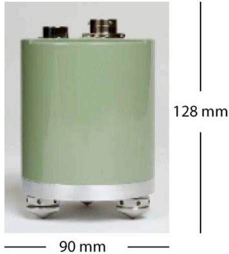
**Figura 3.** Sensore *Trillium Compact 120 s* della *Nanometrics* a corredo della stazione RM29 dal 16 Ottobre 2009 (vedi Allegato B, scheda stazione RM29).
