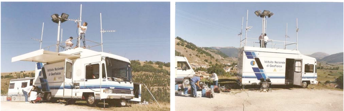
Figura 5. Centro di acquisizione mobile delle stazioni in telemetria UHF realizzato nel 1990 e utilizzato per la prima volta durante il terremoto di Potenza del 1990. In foto è mostrato il suo utilizzo durante la sequenza sismica di Colfiorito (1997-98).
