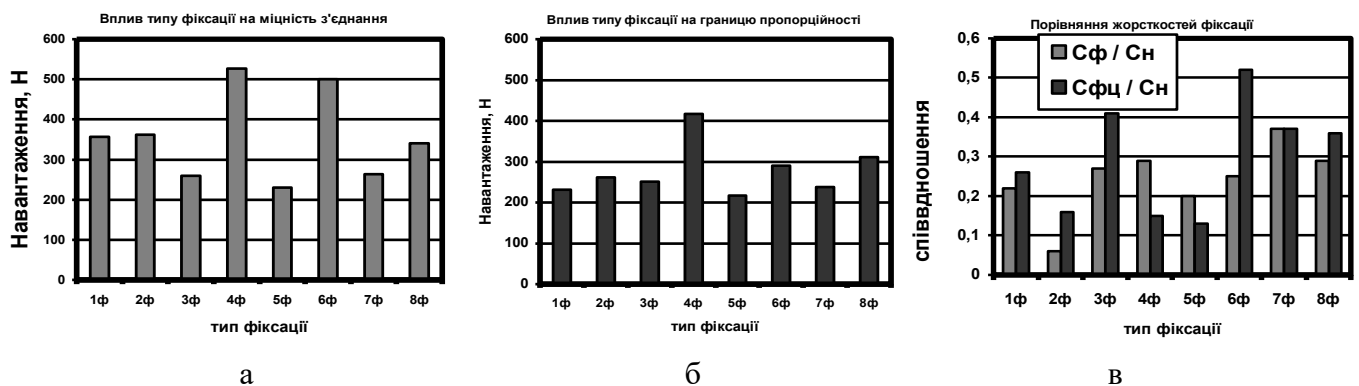
Рис. 14 – Максимальні навантаження, що відповідають початку руйнування (а); навантаження, що відповідають границі лінійної ділянки діаграми деформування (б); співвідношення жорсткостей непошкоджених ТК ( C_n ) та ТК з модельованими переломами і системами фіксації у вихідному стані ( C_f ) та після прикладення циклічних навантажень ( C_{fc} ) (в)
