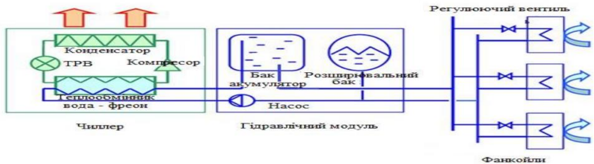
Рисунок 2.5 - Принципова схема роботи системи «чиллер – фанкойл»
