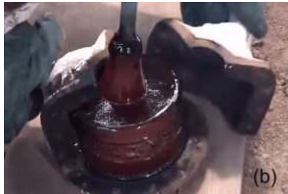
Gambar 1.11. Cara manual pembuatan barang dari kaca yang berongga dengan cetakan dan sistem tiup. Sebelum ditiup, bahan kaca dimasukkan cetakan (a), dan setelah ditiup dikeluarkan dari cetakan (b).
