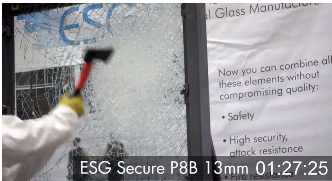
Gambar 2.42. Proses pengetesan secure glass setebal 13 mm (diproduksi oleh ESG) setelah hampir 1 menit 27 detik memperoleh perlakuan vandalisme dengan palu dan kampak yang tajam, namun tetap bertahan tidak pecah. (Sumber www.youtube.co.id/watch?v=F2wdTd8PWk8 )
