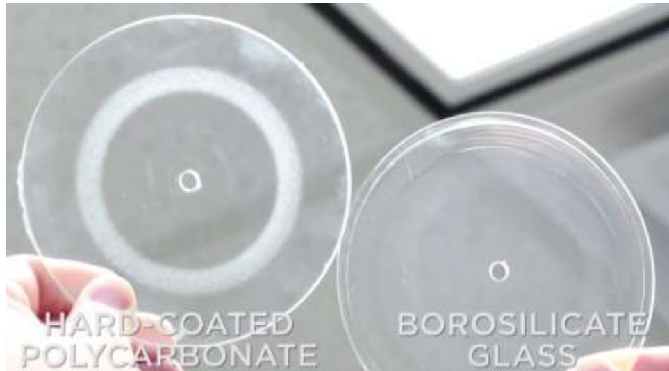
Gambar 5.17. Perbandingan hasil uji abrasi metode Taber untuk polikarbonat dan kaca borosilikat. (Sumber http://www.koppglass.com/blog/mechanical-properties-of-glass-design-to-survive-stress-impact-and-abrasion/ )
