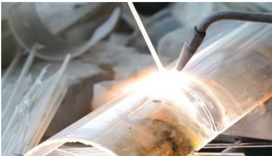
Gambar 9.44. Proses penyambungan kaca lengkung dengan las kaca sistem laser.
