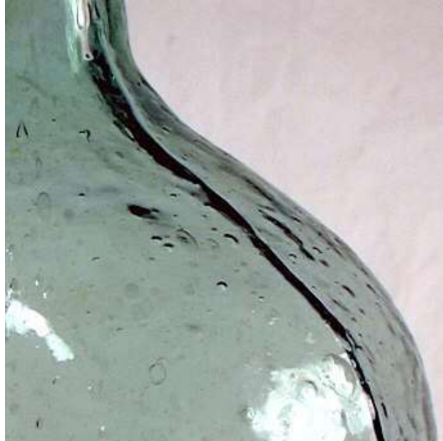
Gambar 2.9. Gelembung pada kaca, yang mengurangi kualitas kaca.
