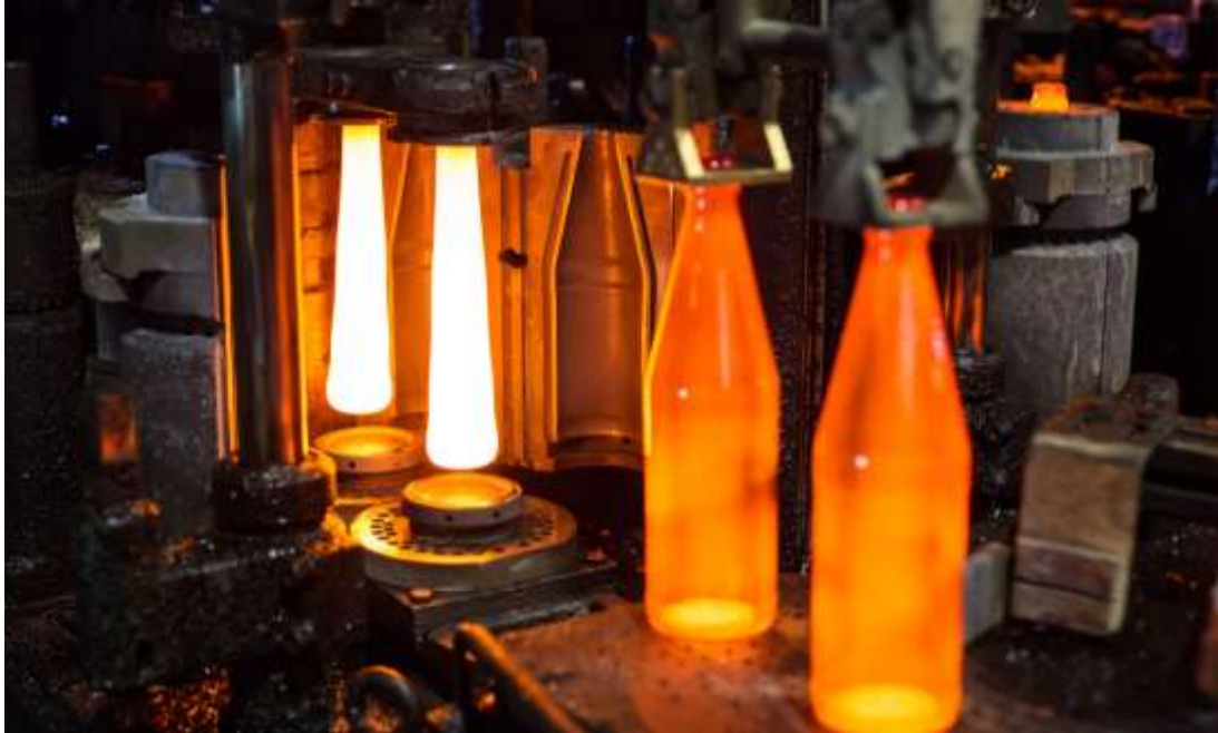
Gambar 2.20b. Industri botol yang menggunakan proses tiup mekanik. (Sumber https://ceramicninja.com/glass-bottle-manufacturing-process/ )
