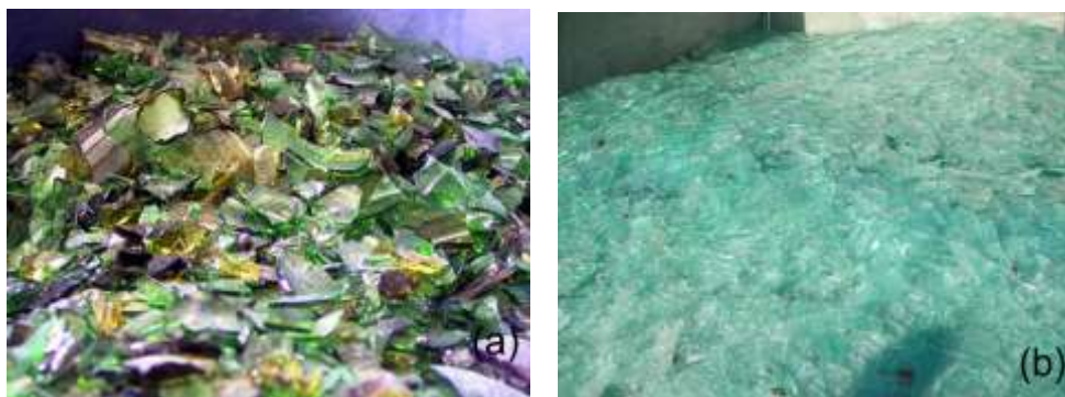
Gambar 2.8. Cullet dari pengepul atau pemulung yang tidak disarankan untuk proses pembuatan kaca lembaran (a) dan sisa industri yang dipergunakan dalam proses selanjutnya (b). (Sumber https://all.biz/the-cullet-is-colourless-g1562982RU dan https://spanish.alibaba.com/product-detail/scrap-glass-cullets-105965092.html )
