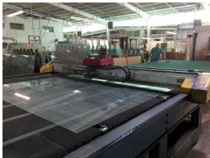
Gambar 9.46. Mesin pemotong kaca otomatis yang digunakan di pabrik kaca.
