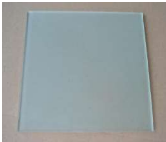
Gambar 2.44. Salah satu kaca yang diburamkan dengan Hydrofluoric acid menjadi kaca satin yang difungsikan untuk memendarkan cahaya.
