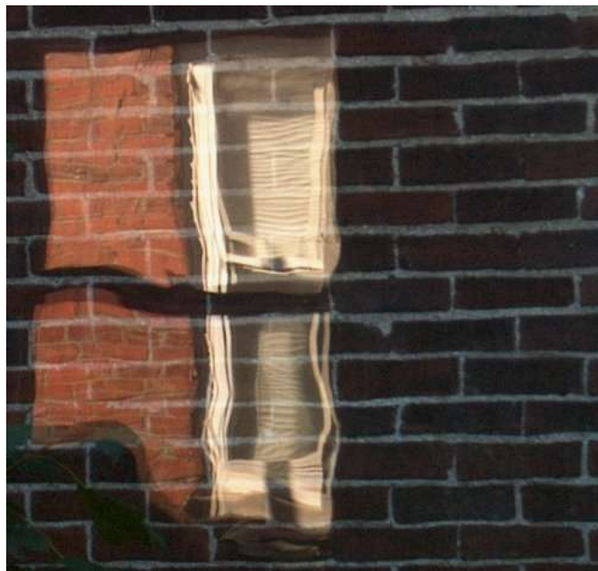
Gambar 8.4. Bayangan kaca jendela yang terkena sinar dan jatuh ke dinding di seberang jendela, menunjukkan bahwa permukaan kaca tidak rata. (Sumber https://en.wikipedia.org/wiki/Architectural_glass#/media/File:DistortedGlass.wmg.jpg )
