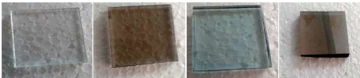
Gambar 6.2. Warna-warna kaca yang dipakai sebagai referensi Tabel 6.4 dari kiri ke kanan CGW, BZGW, GGW, BZRGW. (Sumber Kirankumar dkk., 2017)
