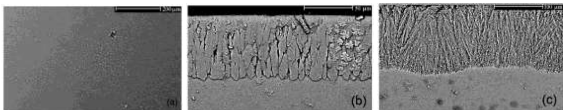
Gambar 5.12. Kaca yang mengalami surface crystallization menggunakan Barium Oksida ( \text{BaO} ), tanpa (a), dengan \text{BaO} 5% (b) dan dengan \text{BaO} 10% (c).
