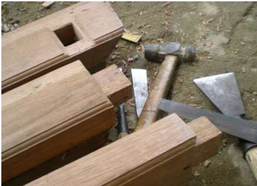
Gambar 9.4. Untuk memenuhi estetika, sisi siku kusen biasanya diberi profil lekuk.
