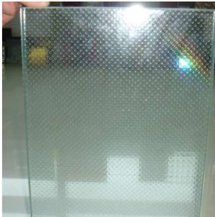
Gambar 8.23. Perlakuan acid etched pada kaca agar tidak licin saat digunakan sebagai lantai.
