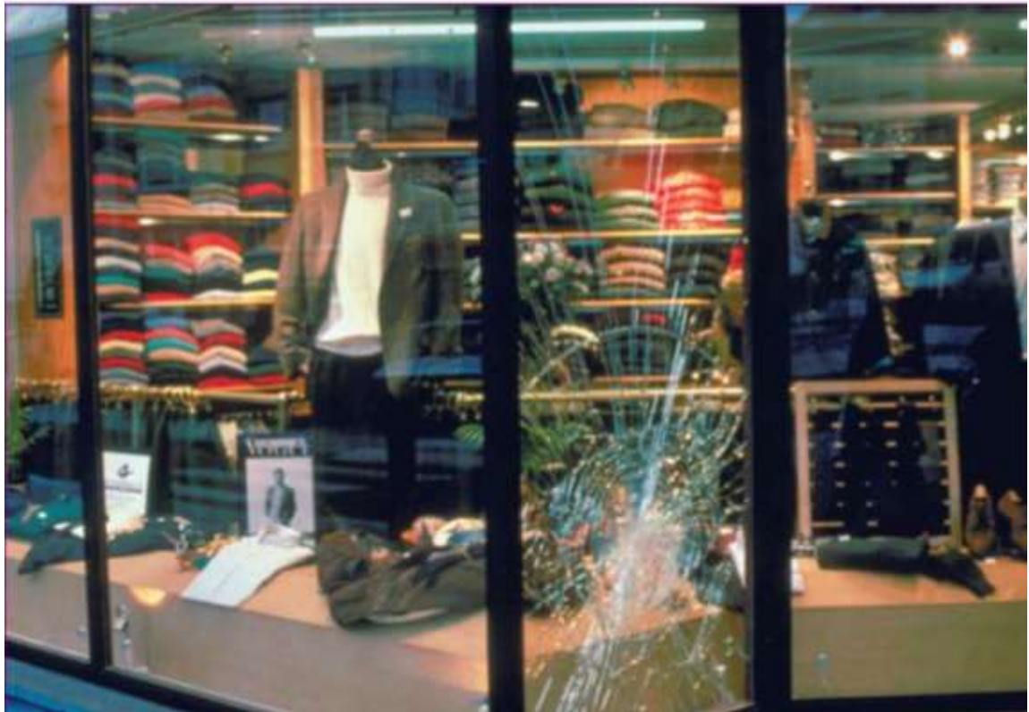
Gambar 2.32. Kaca laminated yang pecah akan membentuk pola sarang laba-laba yang tetap menempel. (Sumber https://www.saflex.com )
