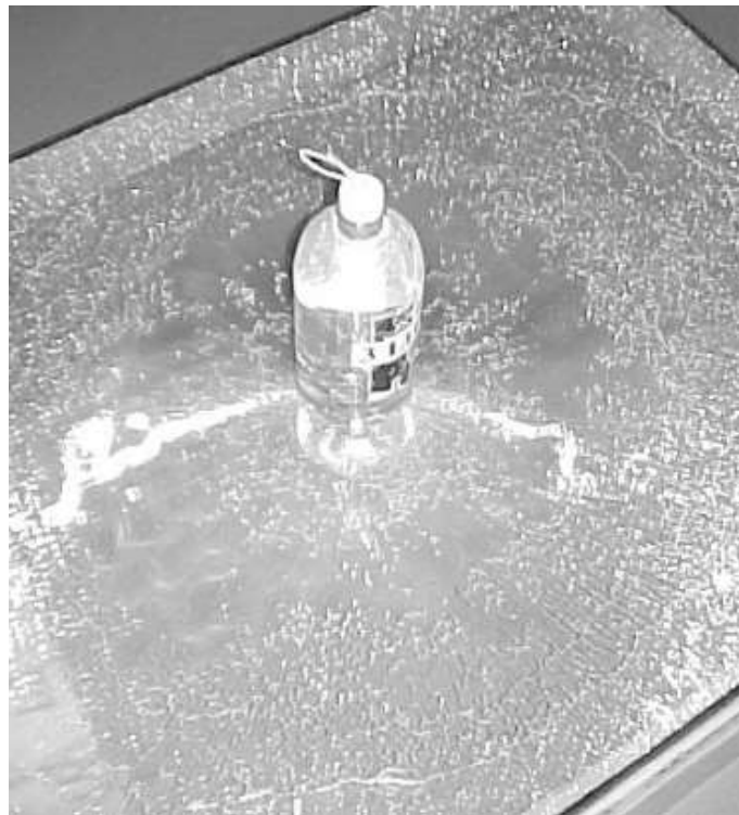
Gambar 5.21. Tampak karakteristik kaca temperasi yang mengalami energy impact , titik posisi impact tidak terlihat jelas, retakan banyak dan sangat kecil-kecil, kaca tidak langsung pecah dan masih mampu menahan beban yang ringan, seperti botol.
