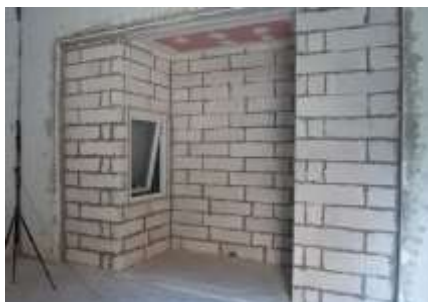
Gambar 7.10. Skematik dan foto penempatan jendela yang diuji dengan posisi bersudut 90^\circ .
