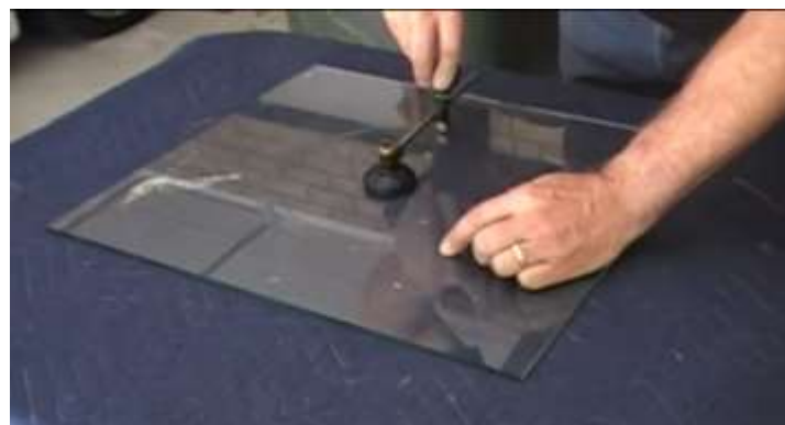
Gambar 9.48. Alat pemotong kaca untuk membentuk lingkaran dengan karet pemegang sebagai titik pusat lingkaran.
