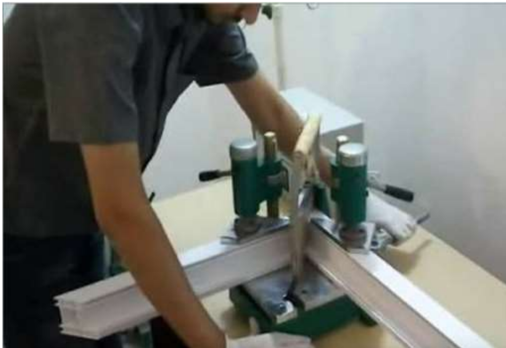
Gambar 9.12. Kusen uPVC lebih kokoh karena sambungan antar material, seperti pada bagian sudut, melalui proses pengepresan dengan suhu tinggi, sehingga material benar-benar menyatu dan lengket (hampir tanpa celah).
