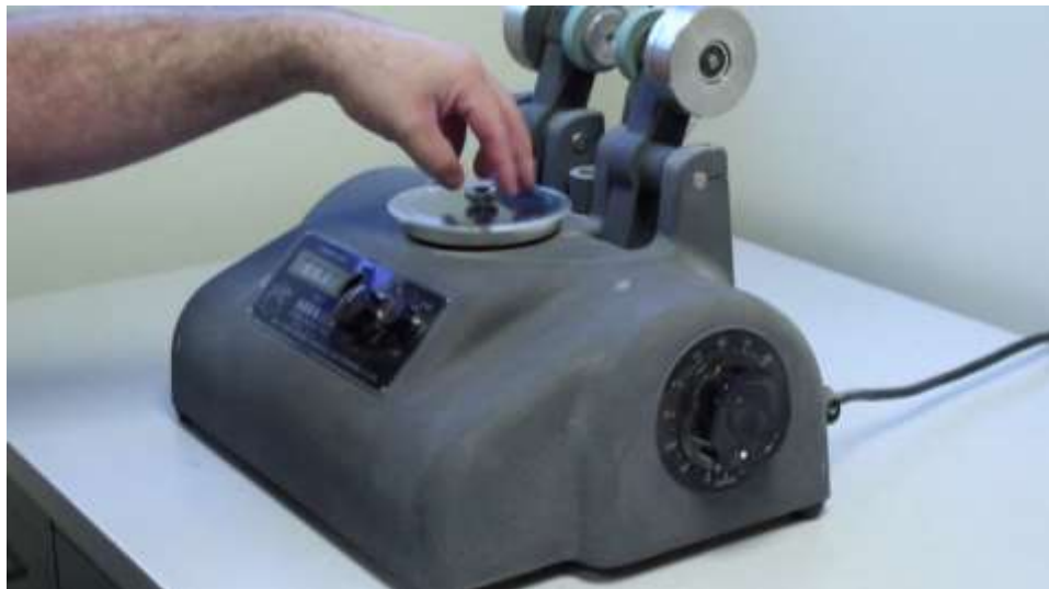
Gambar 5.16. Peralatan untuk menguji kekuatatan material terhadap abrasi dengan metode Taber. (Sumber http://www.koppglass.com/blog/mechanical-properties-of-glass-design-to-survive-stress-impact-and-abrasion/ )
