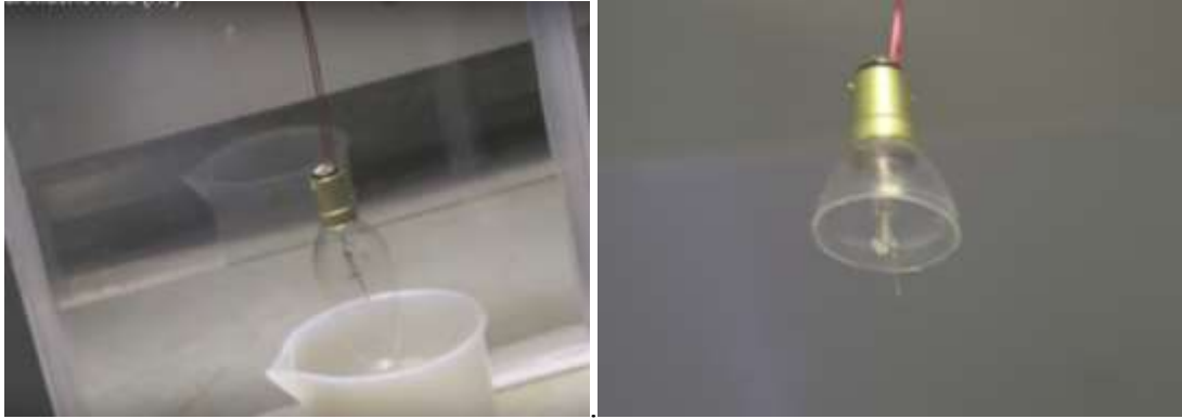
Gambar 5.6. Percobaan bola lampu kaca yang direndam dalam asam Hidrofluoric, putus bohlamnya persis pada batas bagian yang direndam cairan. (Sumber https://www.youtube.com/watch?v=6ZBwluyR2Tc )
