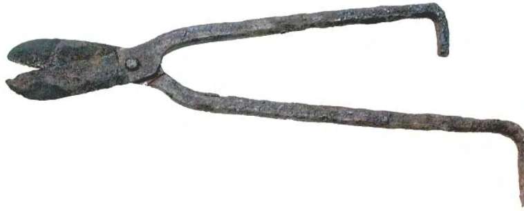
Figura 51. Tijeras de hierro para el recorte de planchas de metal. Cueva de la Soterraña, Valencia. Siglo XVII. Museo de la prehistoria de Valencia www.museoprehistoriavalencia.es
