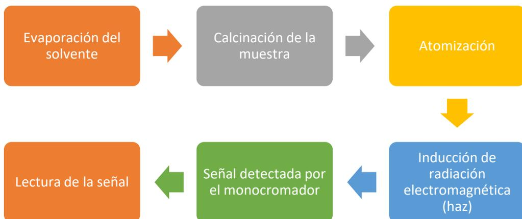
**Figura 20.** Flujograma de análisis de determinación de plomo por espectrofotometría de absorción atómica de horno de grafito.
