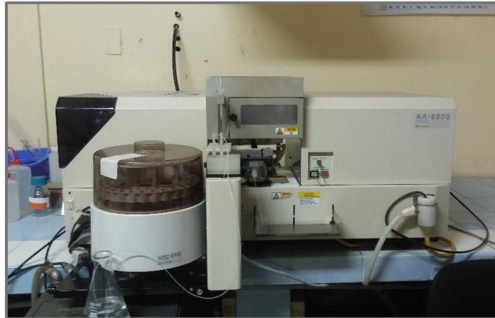
**Figura 13.** Espectrofotómetro de absorción atómica de horno de grafito Marca SHIMADZU, Modelo AA6800. Laboratorio USAQ.
