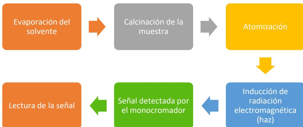
**Figura 18.** Flujograma de análisis de determinación de plomo por espectrofotometría de absorción atómica de horno de grafito.
