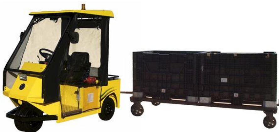
Figura 5. Conceito do veículo estilo rebocador para transporte de carga
