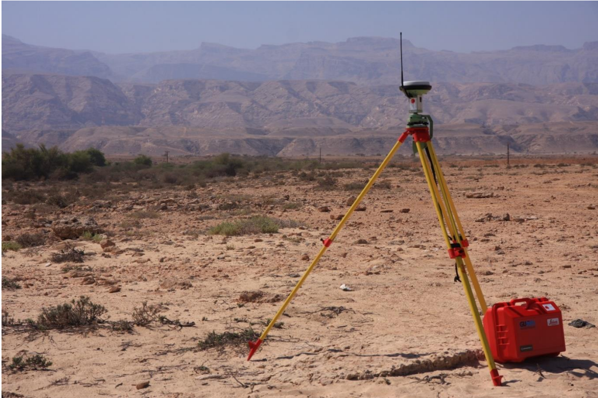
Abb. 4-4: Das zur topographischen Kartierung verwendete Leica dGPS auf T3 bei Fins mit Blick nach Westen. Im Hintergrund sind die Terrassenlevel T4, T5 und T7 in aufsteigender Höhe zu erkennen (Foto: B. Schneider).
