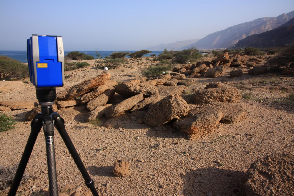
Abb. 3-9: TLS-Datenaufnahme im Untersuchungsgebiet Tiwi mit Blick nach Süden. Die dachziegelförmig gelagerten, plattigen Beachrocks sind hier linear in einem Blockwall angeordnet. Die weißen Kugeln dienen zur Referenzierung der Einzelscans (Foto: B. Schneider).
