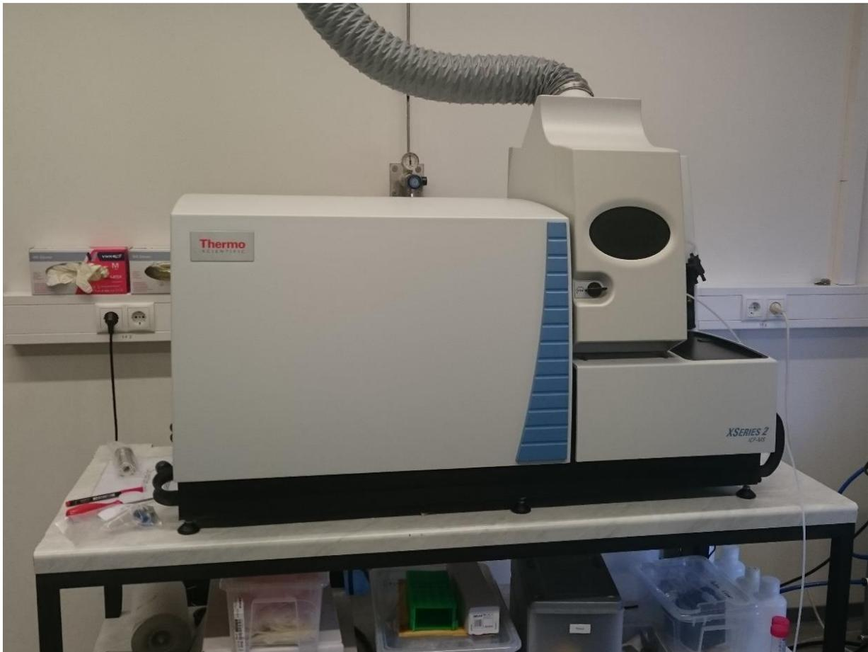
**Abb. 9:** Massenspektrometer mit induktiv gekoppeltem Plasma (X Series II™, Thermo Fisher Scientific, Waltham, USA) des Bonner Steinmann-Instituts, das in dieser Arbeit verwendet wurde.
