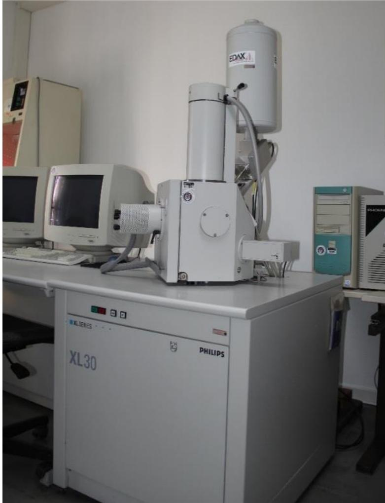
**Abb. 10:** In dieser Arbeit eingesetztes Rasterelektronenmikroskop (Philips XL 30) des Zentrums für Zahn-, Mund- und Kieferheilkunde der Universität Bonn.
