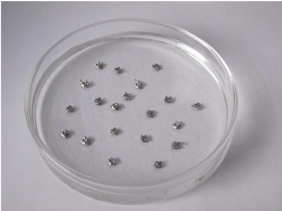
**Abb. 6:** Darstellung des Versuchsaufbaus des statischen Immersionstests. Die Brackets waren vollständig in das Korrosionsmedium getaucht und hatten keine Berührung untereinander.
