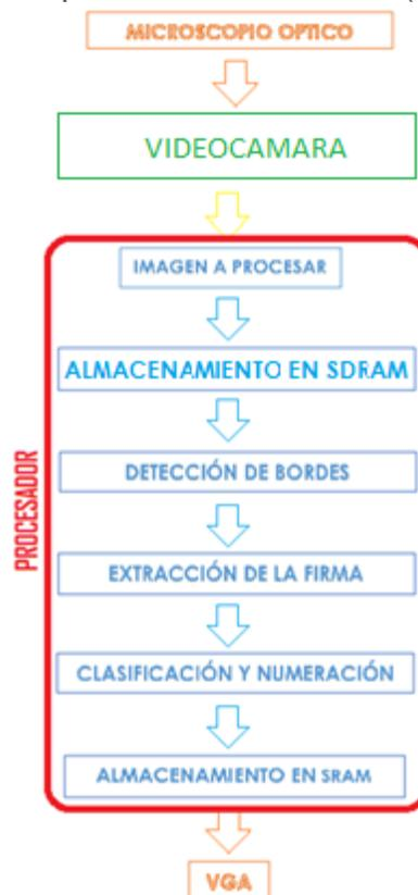
**Figura 1.** Diseño de algoritmo.
