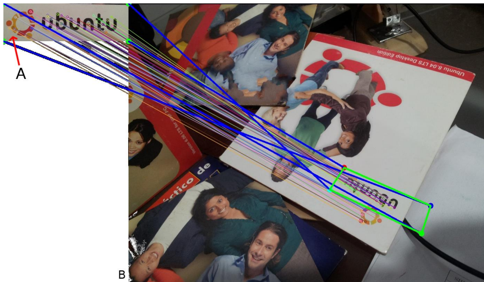
Figura 10: Detección de objetos, imagen A logo de Ubuntu, imagen B discos collage de Ubuntu.
