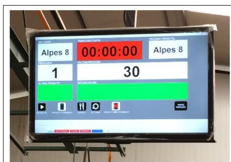
Figura 28 - Quadro Andon com estado da produção em tempo real.
