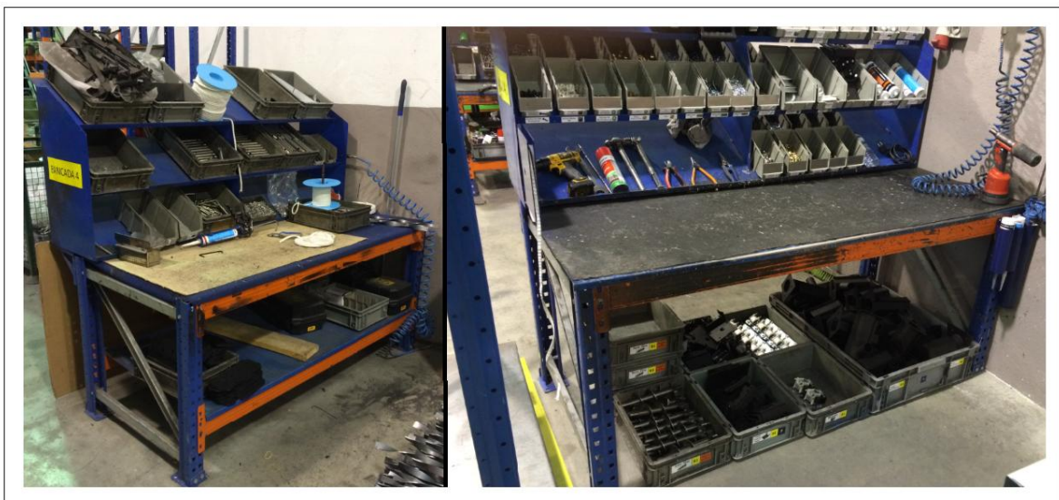
Figura 18 - Bancada sem 5S's (à esquerda) vs bancada após 5S's.
