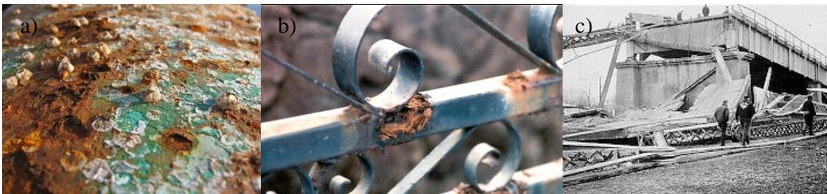
**Figura 2.1** – Aspeto típico de estruturas metálicas atacadas pela corrosão (a, b); queda da ponte “Silver Bridge” no estado da Virgínia Ocidental (EUA) em 1967, causada pelo prolongamento da combinação de tensões de tração e ambiente corrosivo sobre uma zona crítica da estrutura (fissura) (c) [2-4].
