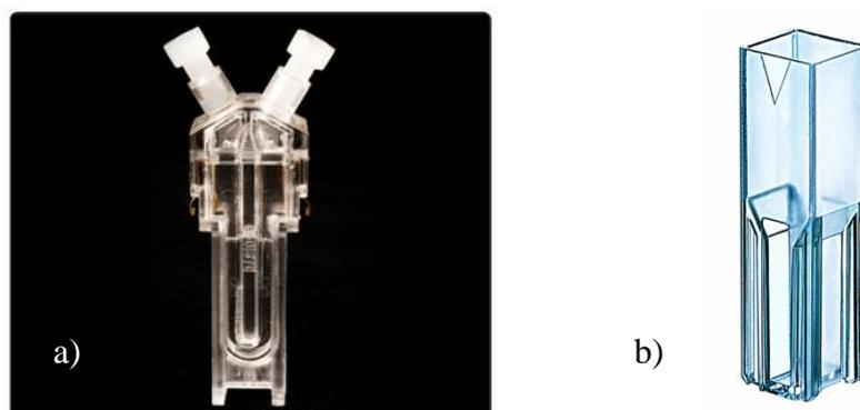
**Figura 4.5** – Cuvete para medição do potencial zeta (a) e medição do tamanho das partículas (b) [40,41].
