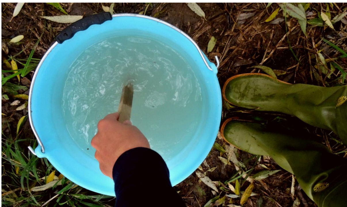
Slika 22: Priprava sledila-mešanje soli
