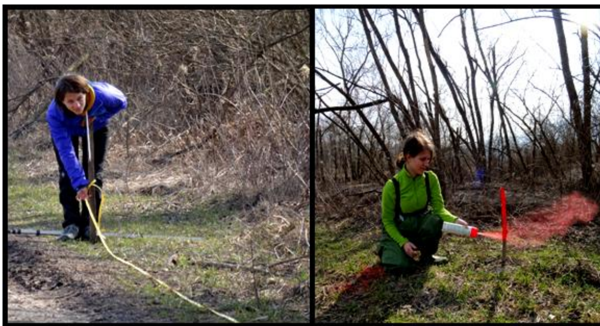
Slika 19: Merjenje razdalj med prečnimi profili in označevanje profilov (Piltaver, 2015)
