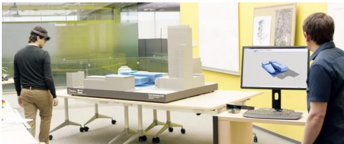
Slika 11 - Prikaz uporabe HoloLens – kolaboracija Trimbla in Microsofta (Phillips; Trimble. 2015)
