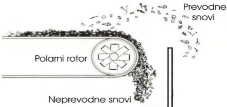
Slika 7: Ločevalnik neželezovih kovin (Zupančič, 2007)
