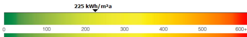
Slika 6: Letna dovedena energija za delovanje stavbe na enoto kondicionirane površine stavbe
