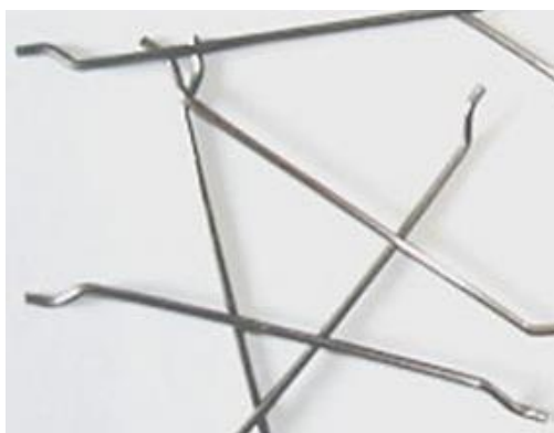
Slika 1: Vlakna s kljukastima koncema
