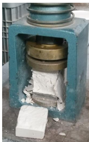
Slika 20: Enoosni tlačni preizkus v standardni preši
