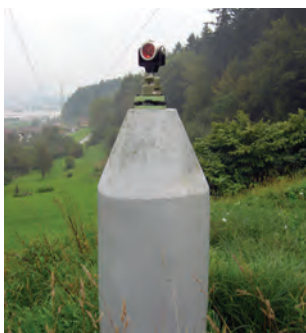
Slika 2: Stabilizacija točke z betonskim stebrom in jeklenim klinom.
