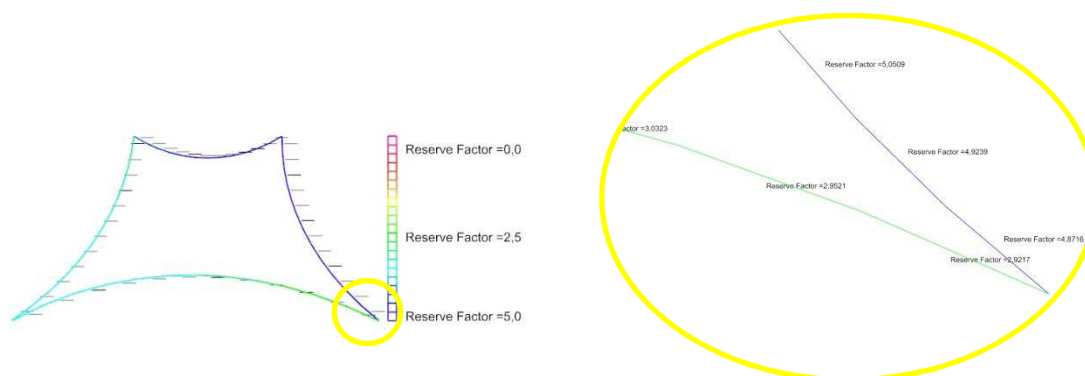
Slika 6-65: Varnostni faktor v robnih kablji stranske membrane pri obtežnem primeru št. 2 in povečava območja z najnižjimi faktorji
