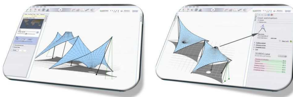
Slika 3-1: Delo v programu FormFinder: analiza osenčenosti (levo) in ocena stroškov (desno) [16]
