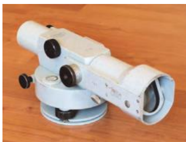
Slika 4: Nivelir Ni2 (Tuno N., Kogoj D., 2012)
