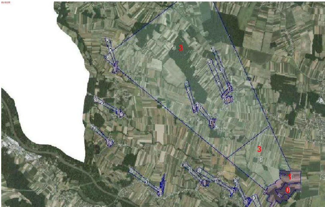
Slika 7: Prikaz vodovarstvenega območja za črpališče Črnske meje, številke označujejo vodovarstvene pasove (Tomaž Žitek 2014)
