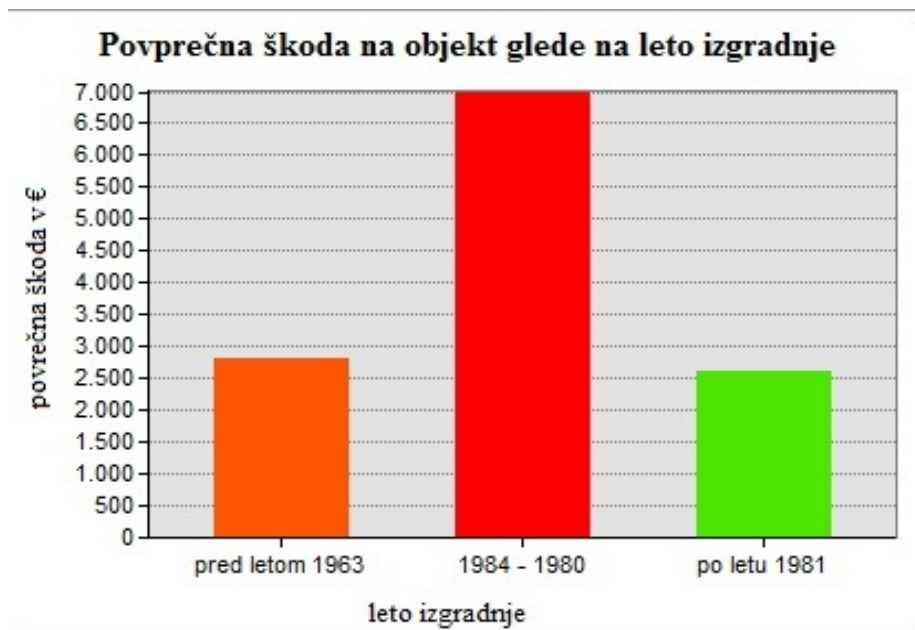
Slika 6: Graf povprečne škode glede na leto izgradnje stavb, zgrajene na pogojno primernih tleh (Šušteršič, 2012).
