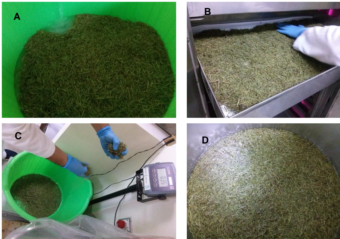
Figura N°26: Elaboración de los extractos. A) Lavado de material vegetal, B) secado de material vegetal, C) pesado de material vegetal y D) almacenamiento del material vegetal más solvente en recipiente de acero inoxidable.
