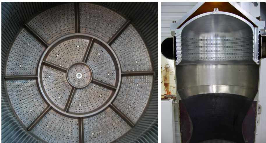
Abbildung 2.10: Links: Einspritzkopf des F-1-Triebwerks der Saturn V, rechts: Radiale Einspritzung beim Viking-Triebwerk
