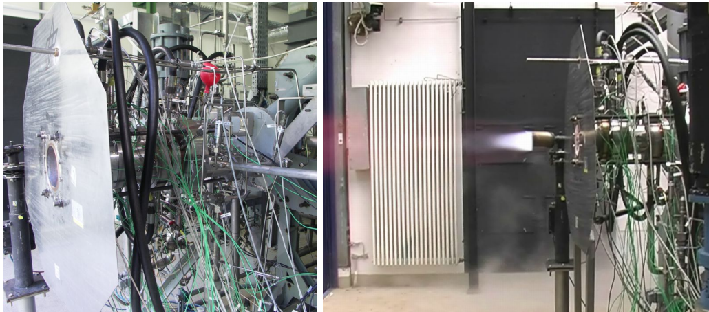
Abbildung 3.17: Links: API80-168 V2 mit Brennkammer „D“ und Hitzeschild am Prüfstand P8, rechts: Heißgasversuch mit API80-168 V2 am P8
