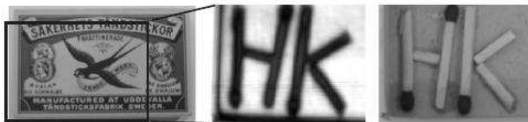
Rysunek 1.13: Zdjęcie pudełka z zapawkami wykonane w zakresie terahercowym (po środku). Jako odniesienie zamieszczono zdjęcia w świetle widzialnym zamkniętego pudełka (po lewej stronie) oraz wnętrza pudełka otwartego (po stronie prawej) [86].
