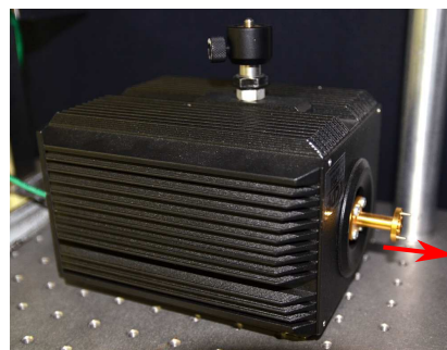
Rysunek 3.6: Karcinotron skonfigurowany do świecenia w zakresie 100–170 GHz. Czerwona strzałka wskazuje zgrubnie kierunek świecenia.
