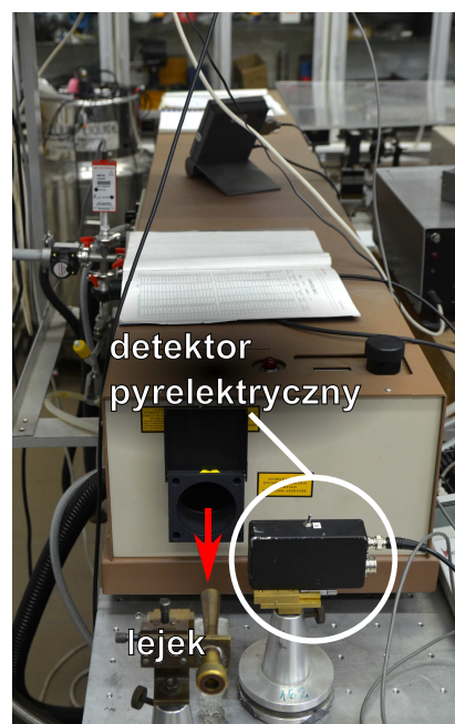
Rysunek 3.4: Obudowa laserów molekularnego i CO 2 . Widok od strony wyjścia lasera molekularnego.
