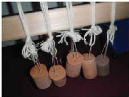
93. Mocowanie brzegu początkowego do podwójnej belki nawoju (praca J. Witulskiej)
