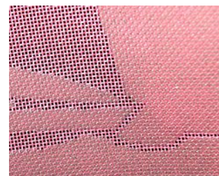
RYS. 100 – Siatka sitodrukowa pokryta utwardzoną matrycą światłoczułą [395].
