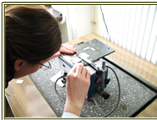
RYS. 130 – Analiza elektrod sitodrukowanych za pomocą profilografometru. Zdjęcie wykonane w Zakładzie Materiałów Grubowarstwowych Instytutu Technologii Materiałów Elektronicznych w Warszawie dzięki uprzejmości dr Elżbiety Zwierkowskiej i dr Selima Achmatowicza.
