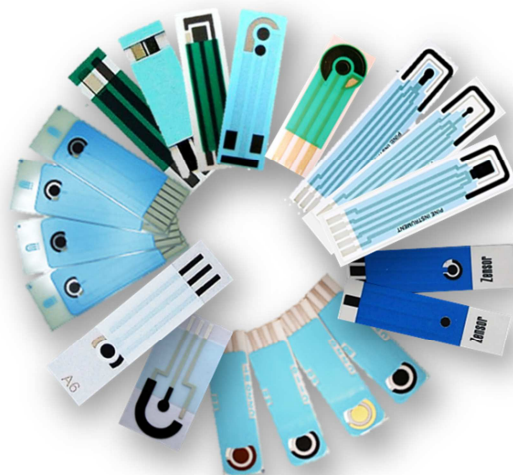
RYS. 104 – Sitodrukowane czujniki elektrochemiczne różnych producentów [400-405].
