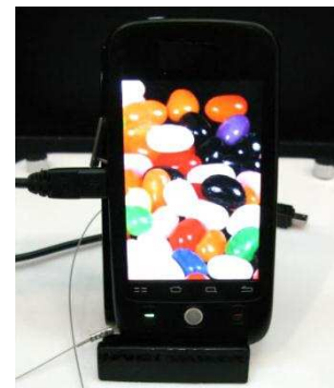
RYS. 114 – Panel dotykowy z CNT skonstruowany przez firmę Chi Mei Optoelectronics [444].
