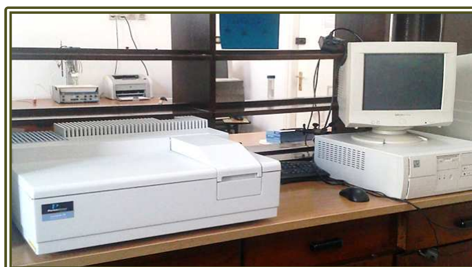
RYS. 132 – Spektrofotometr UV-Vis Perkin Elmer sprzężony z komputerem.
