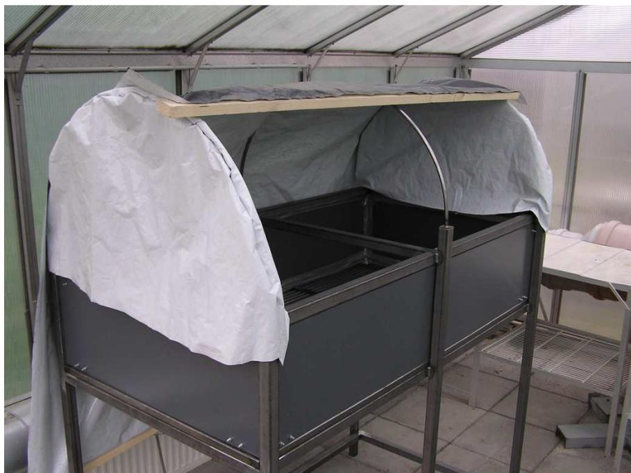
Abbildung 7: Außenansicht der 300-L-Rottereaktoren
