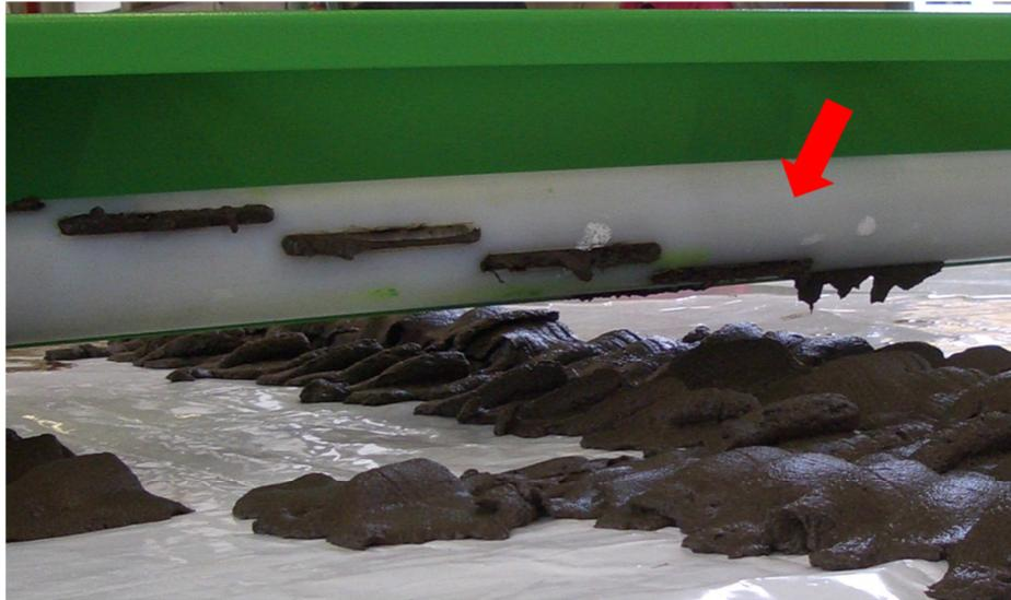
Abbildung 10: Applikationseinheit des Komposters (Markierung: äußeres Rohr) mit den versetzt angebrachten Schlitzfenstern
