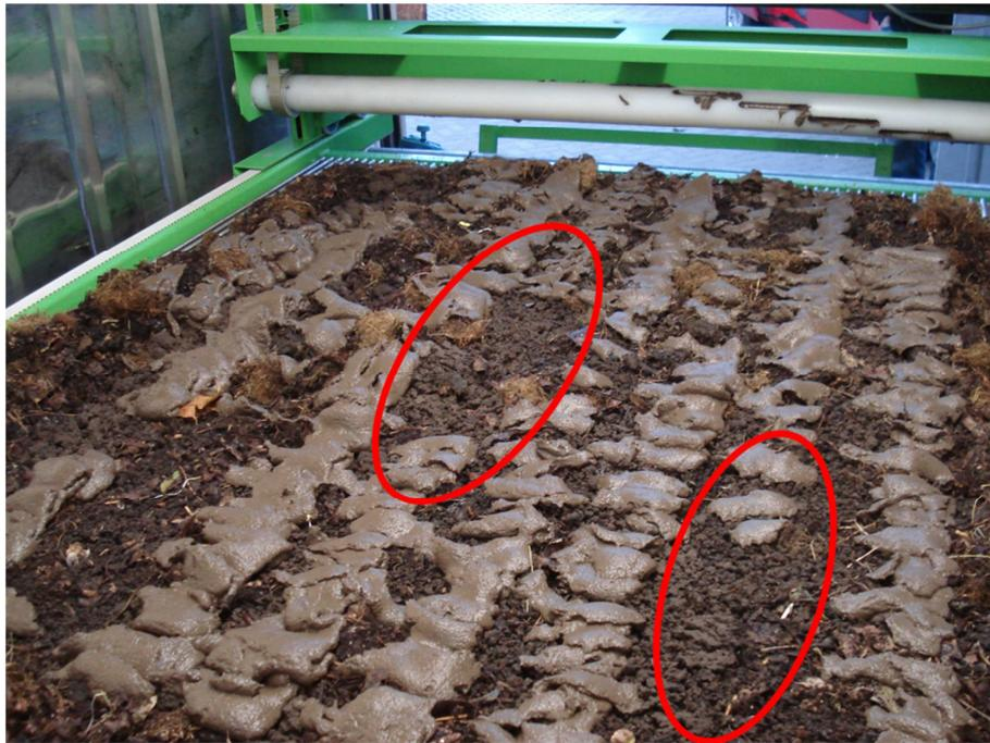
Abbildung 34: Ablagebild der Applikationseinheit (ausgebrachtes Material: Überschussschlamm), in den roten Umrandungen sind Lücken im Ablagebild markiert.
