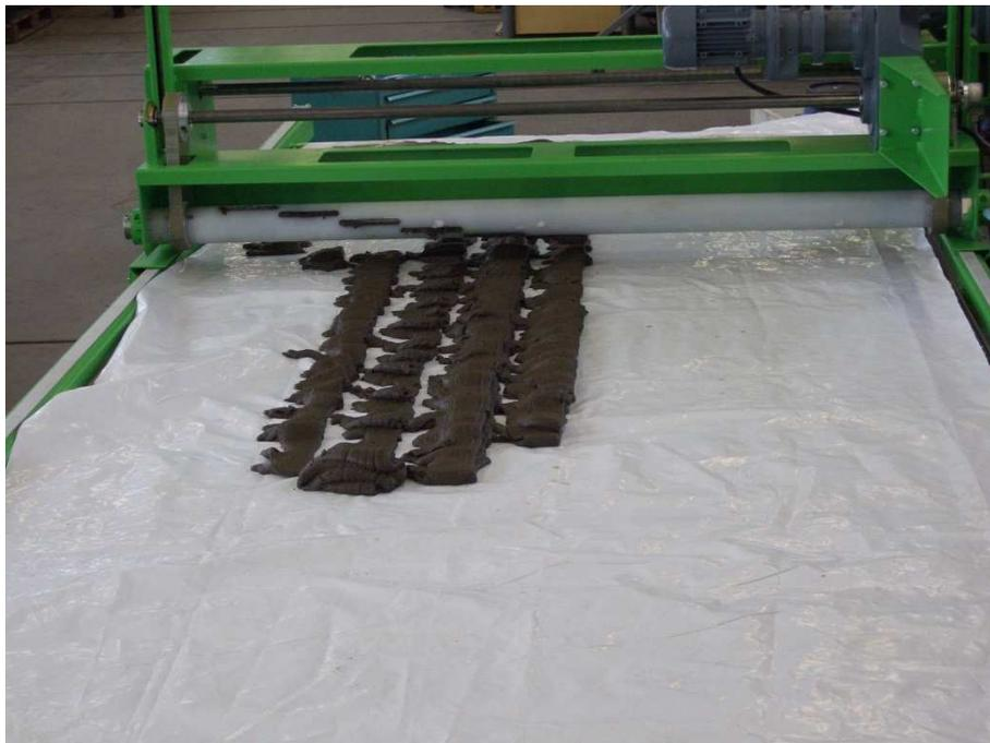
Abbildung 12: Ablagebild der Applikationseinheit auf dem Komposter bei Vorversuchen mit Überschussschlamm, der Gitterboden wurde mit Folie abgedeckt.
