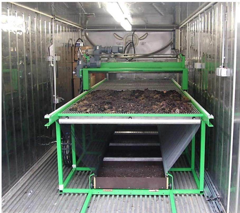
Abbildung 13: Gesamtansicht des zum Teil mit Bioabfall belegten Komposters. Unterhalb des Gitterbodens sind die Gazebahnen und Auffangboxen zu erkennen.
