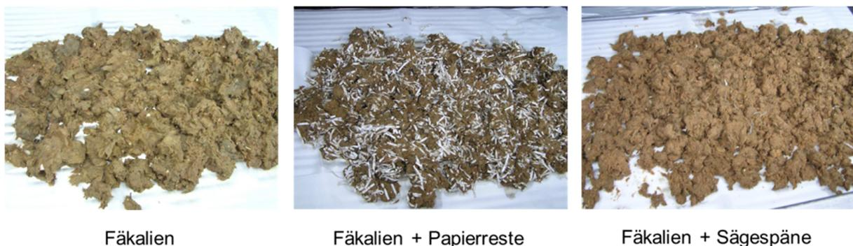
Abbildung 21: Ausgangssubstrat Fäkalien und die Mischungen mit zwei verschiedenen Zuschlagsstoffen (Papierreste und Sägespäne)
