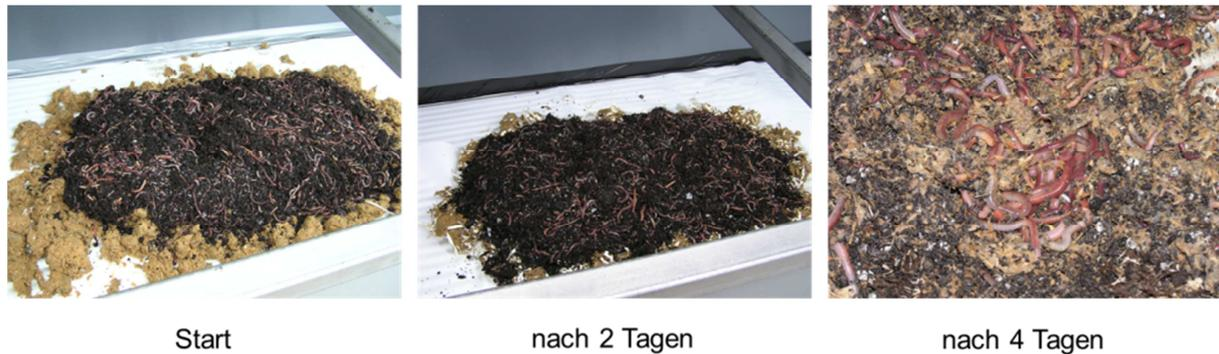
Abbildung 22: Einsetzen der Würmer in die Versuche mit den Co-Substraten. „Start“: Würmer plus Überdauerungssubstrat (dunkel) sind frisch zugegeben, nach 2 Tagen ist das Überdauerungssubstrat bereits durch die Aktivität der Würmer breit verteilt, nach 4 Tagen haben die Würmer das Überdauerungssubstrat in die Fäkalien eingemischt (Bild zeigt Blick in das Material).
