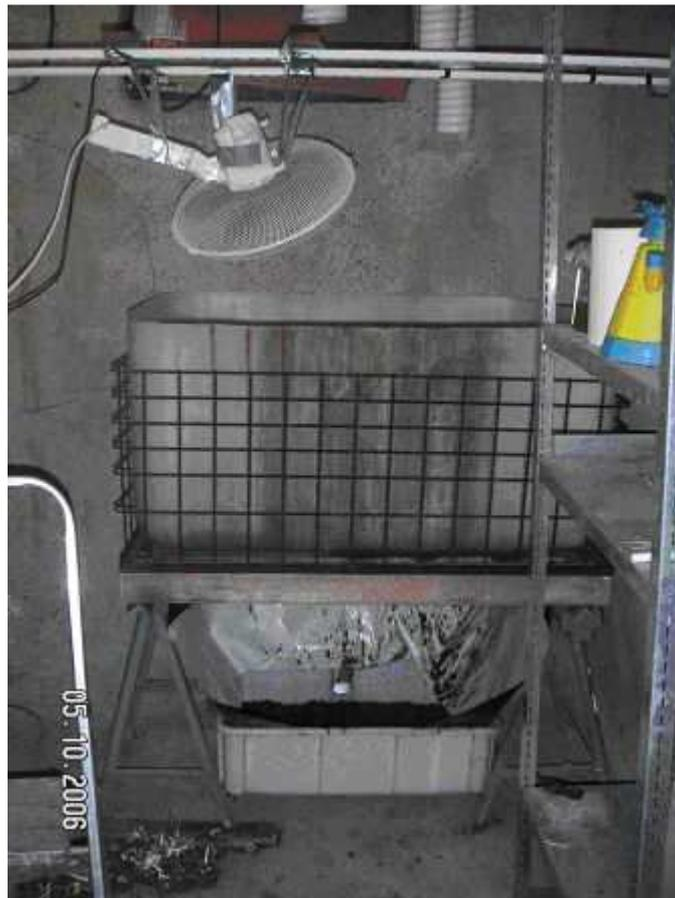
Abbildung 4: 500-L-Box mit Auffangbehälter
