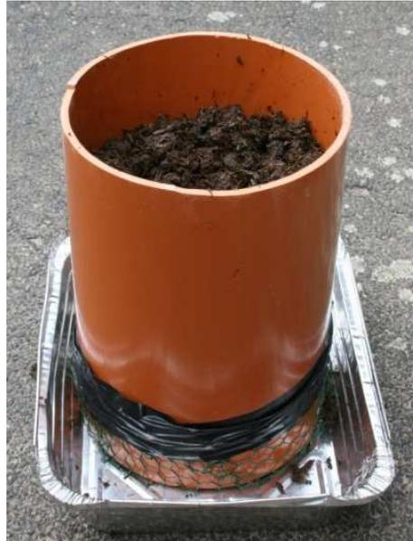
Abbildung 6: 9-L-Versuchs-Komposter (mit Substrat) für Akzeptanzuntersuchungen mit kommunalem Bioabfall und Überschussschlamm (im Bild: kommunaler Bioabfall).
