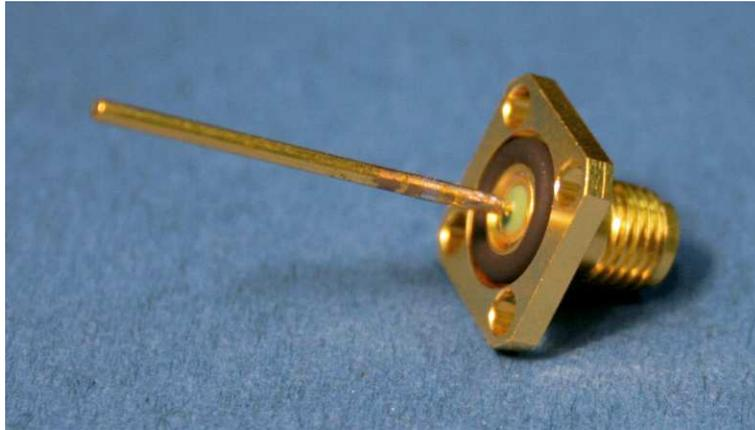
**Abbildung 7.5:** Koppelantenne für einen der Lageresonatoren, welche durch Lötten an einer luftdichten SMA-Durchführung befestigt wurde. Das Bild wurde vor der Kürzung auf die zum Erreichen des gewünschten Koppelfaktors erforderliche Länge aufgenommen.
