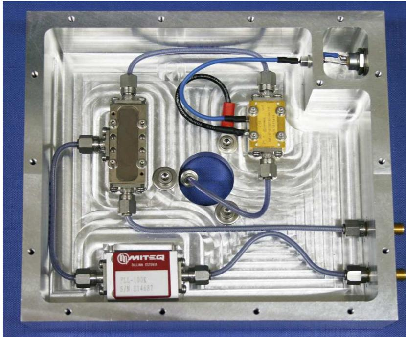
**Abbildung 11.2:** Hochfrequenzdichtes Gehäuse zur Montage oberhalb der Koppelvorrichtung des neuen Stromresonators. Es enthält die Komponenten zur Vorverstärkung, Frequenzmischung und Filterung der Messsignale.
