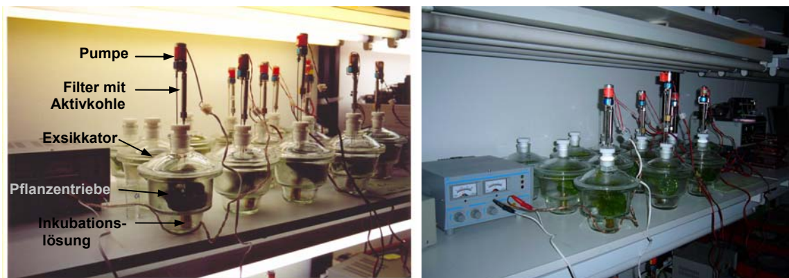
Abbildung 4.45 Versuchsaufbau der „Closed Loop Stripping“-Analyse zur Anreicherung von flüchtigen Blattinhaltsstoffen. Die Inkubation der Pflanzenriebe erfolgte in geschlossenen Glasexsikkatoren über 48 h in Lösungen mit deuterierter Mevalonsäure ( d_2 -MVA) bzw. deuterierter Deoxyxylulose ( d_2 -DOX). Die während dieser Zeit emittierten Duftstoffe wurden auf einem Aktivkohlefilter angereichert. Dazu wälzte eine Miniaturpumpe den Luftraum in den Exsikkatoren kontinuierlich um. Links: Tagphase (10 h Licht mit einer Intensität von ca. 4000 Lux), Rechts: Nachtphase (14 h Dunkelheit).
