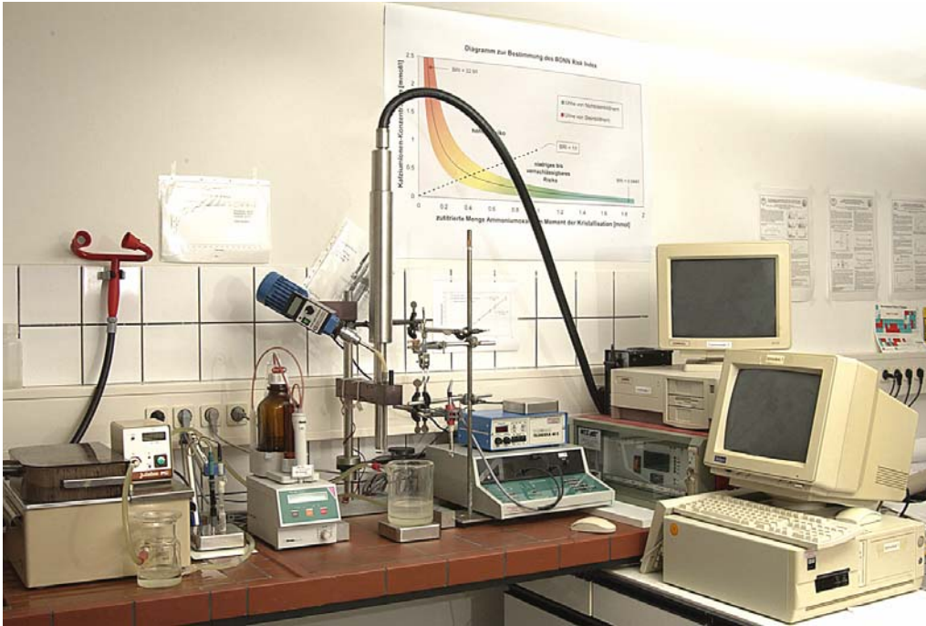
Abbildung 4: Arbeitsplatz mit Photometer, In-line Lasersonde ( Meßtechnik Schwarz GmbH, Düsseldorf, Deutschland ), Titrierautomat (Titrino), calciumselektiver Elektrode ( Metrohm, Herisau, Schweiz ).
