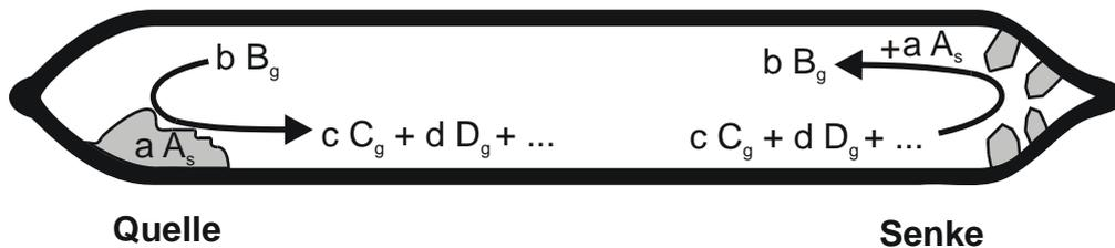
**Abbildung 1.1** Schema zum CVT im Temperaturgradienten ( $T_2 > T_1$ ).
