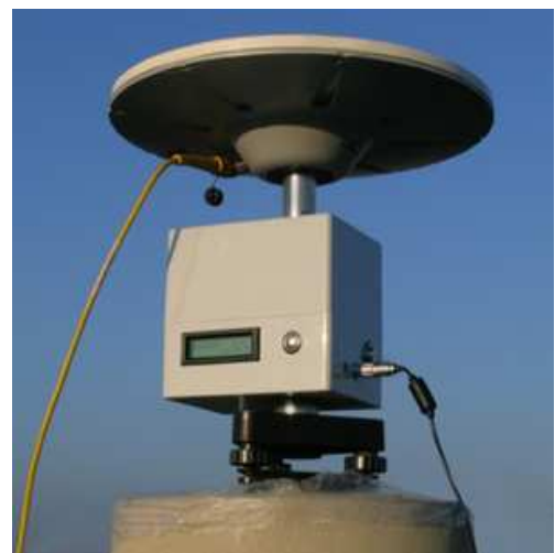
Abb. 5.2: Kalibriermechanik DRB 2 für die Relativkalibrierung mit Antennendrehung (Foto: Geodätisches Institut - TU Dresden).
