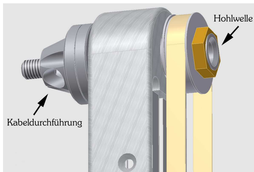
Abb. 8.22: Azimutachse des Drehstandes mit Hohlwelle zur Kabeldurchführung.
