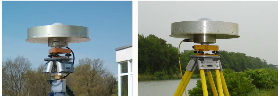
Abb. 10.1: Kalibrierung einer GNSS-Antenne unter Berücksichtigung von Nahfeldkomponenten (Foto: SCHMITZ und WÜBBENA 2007).
