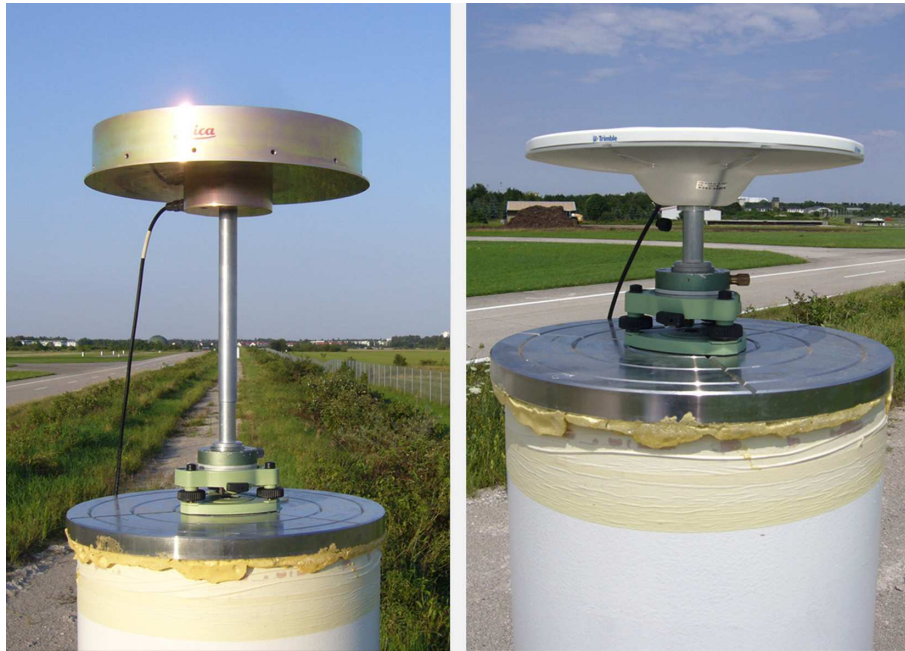
Abb. 11.11: Pfeiler und Antennenmontierung.
