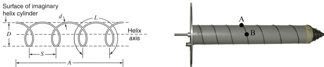
Abb. 7.7: Prinzipskizze (KRAUS u. MARHEFKA 2003) und Abbild einer Helixantenne.
