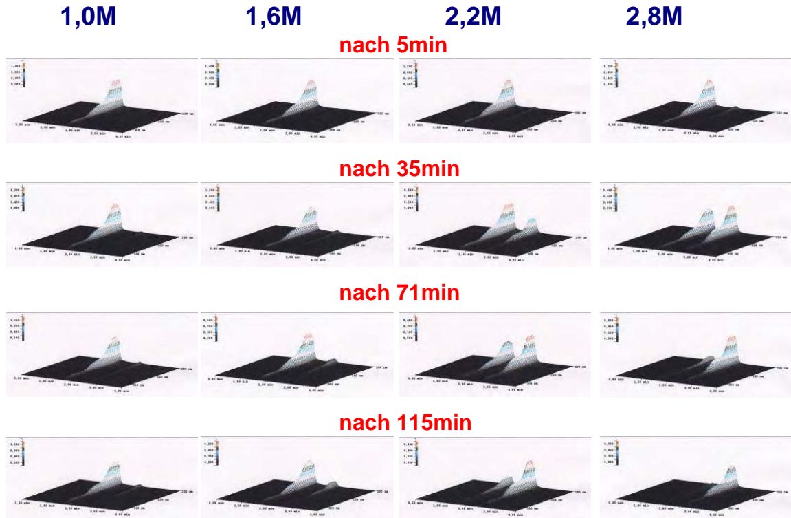
Abb. 3.49: Decarboxylierung von Pyromellitsäure durch verschiedene Fraktionen der Ammoniumsulfatfällung eines Rohextraktes von LFG19a (0,01% Pyromellitsäure in Kaliumphosphatpuffer (50mM, pH 6,5); Zugabe von je 1mg Proteinlösung zu 1mL Testansatz. Die höchste Decarboxylaseaktivität für Pyromellitsäure befindet sich in der Fraktion 2,4-2,8M Ammoniumsulfat.
