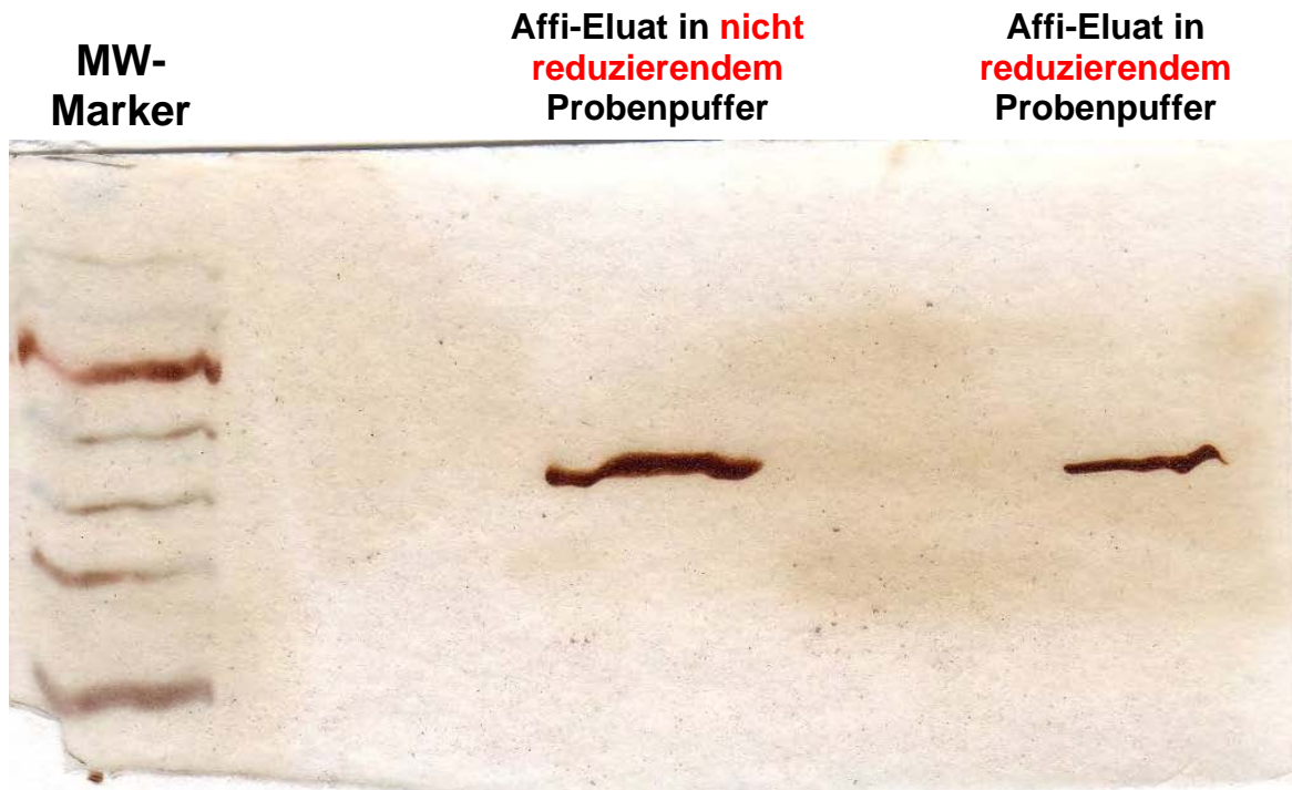
Abb. 3.42: Gelelektrophoretische Auftrennung des Eluates der zweiten LAC. Außer der Decarboxylase ist keine weitere Proteinbande im Gel erkennbar. Die Reduktion mit Mercaptoethanol blieb ohne Auswirkung auf das Verhalten des Proteins bei der SDS-PAGE.
