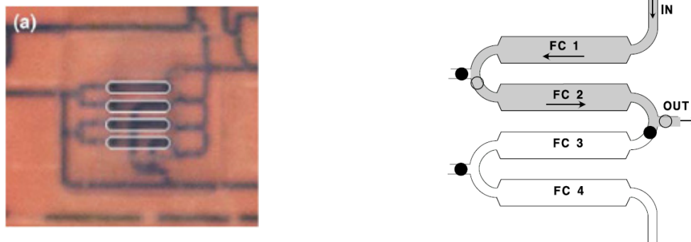
Abb. 2.8 : Links: Flusszellen des Biacore® 2000 (entsprechen in der Anordnung dem Biacore® 3000). Zur Visualisierung wurde schwarze Farbe in das Flußsystem gespritzt. Die Mikrokanäle des Mikroflusssystems, die die Probe zu den Flusszellen transportieren, sind im Hintergrund zu sehen. Quelle: Rich und Myszka, 2004.
