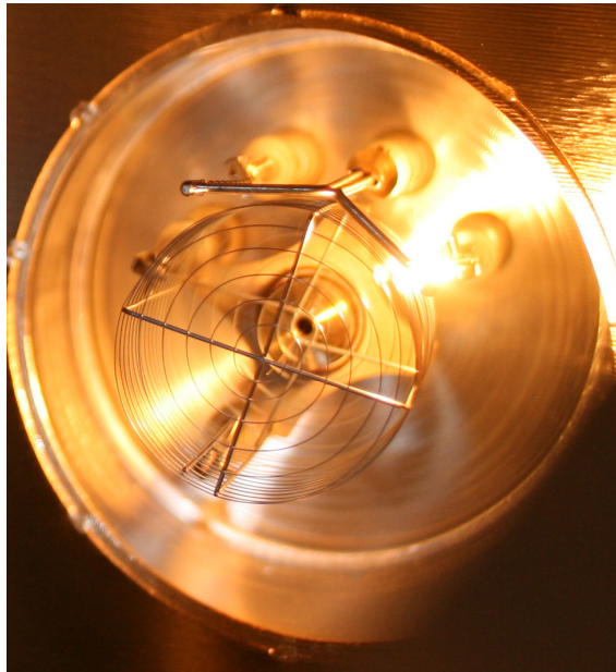
Abbildung 6.4: Die in der Aufbewahrungskammer installierte Heißkathodenmessröhre. Gut zu erkennen ist das hell leuchtende Filament und der zylindrische Anodenkäfgen.
