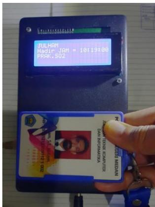
Gambar 10. Tampilan unit baca saat kartu RFID didekatkan
