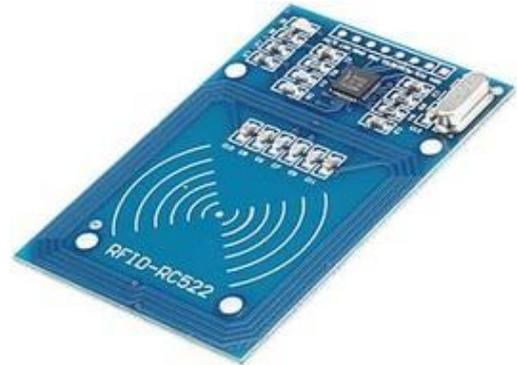
Gambar 5. Modul RFID
