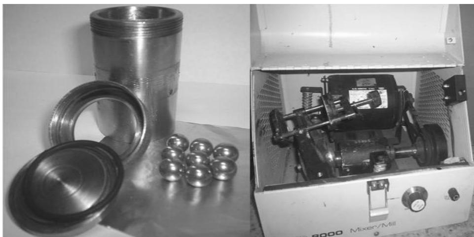
**Figura 5:** À esquerda: pote, tampa, esferas e anel de vedação. À direita: moinho SPEX 8000 CertPrep.
