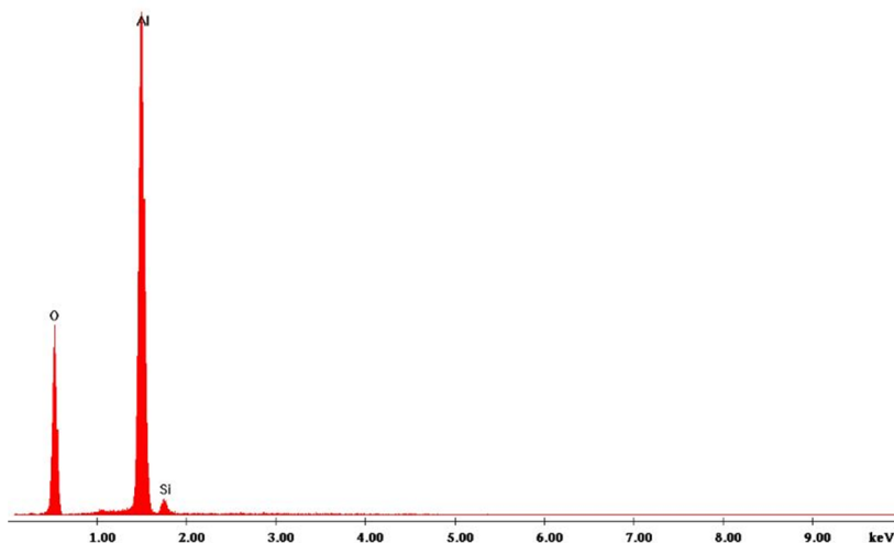
Figura 62: Análise química das partículas cristalinas de alumina presentes na microestrutura dos materiais.
