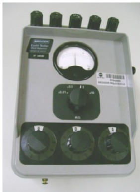
Figura 6.3 - Equipamento de medição da resistividade de terra.
