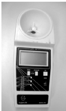
Figura 6.2 - Equipamento de medição da altura dos cabos.
