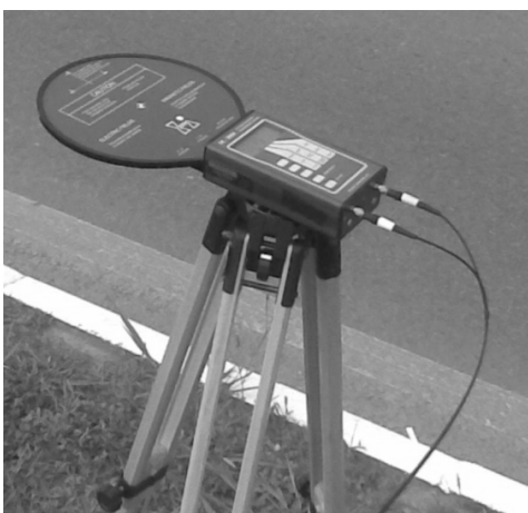
Figura 5.1 – Medidor de campos HI-3604 montado sobre tripé conectado ao leitor remoto.
