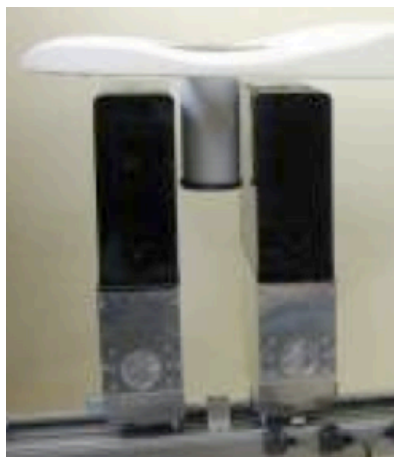
Figura 5.4 Fantoma cilíndrico posicionado entre as cabeças detectoras do scanner ClearPEM.
