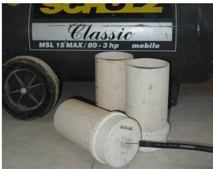
**Figura 21** - Moldes de PVC com o ar comprimido acoplado para a desmoldagem.
