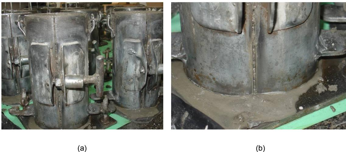
**Figura 23** - Molde metálico com vazamento sistemático: (a) vista geral, (b) detalhe da base.
