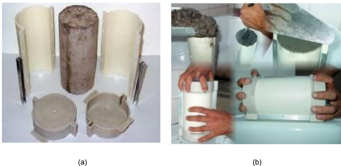
**Figura 12** - Molde em resina: (a) com os seus componentes e o corpo-de-prova desmoldado (b) na moldagem do corpo-de-prova e endurecimento na horizontal (ROCHA, 2002).
