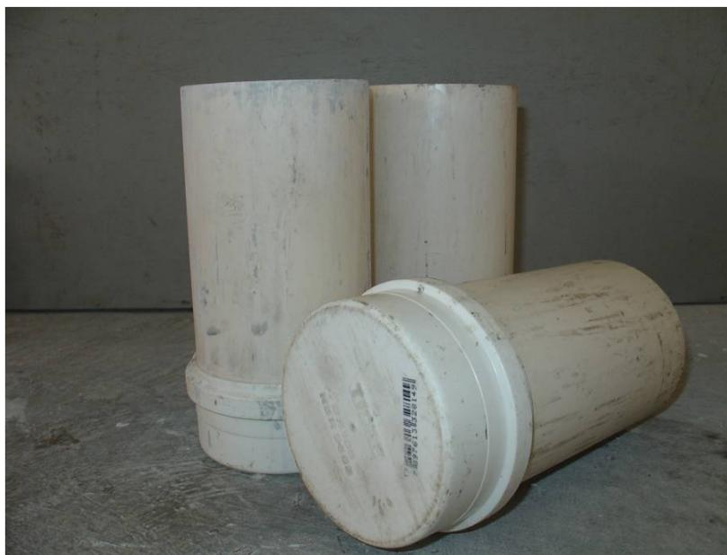
**Figura 13** - Moldes de PVC estanque.
