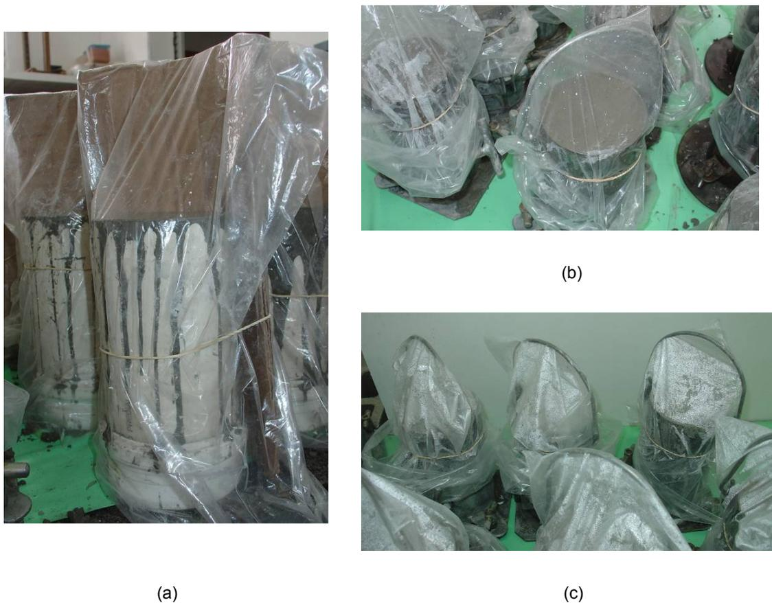
**Figura 25** - Proteção superficial dos corpos-de-prova: (a) molde de PVC, após a moldagem, (b) molde metálico, após a moldagem, (c) desmoldagem, com gotas de água no saco plástico.
