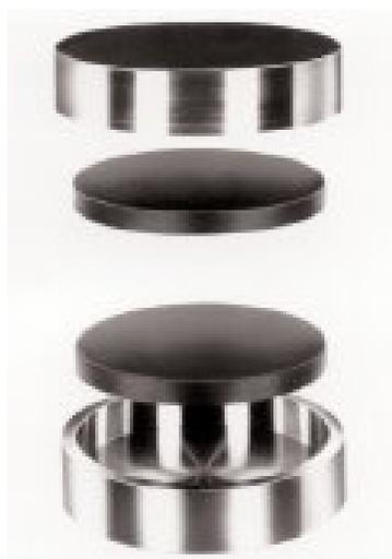
**Figura 16** - Suportes metálicos e neoprene para o capeamento não aderente (PCA, 2006c).
