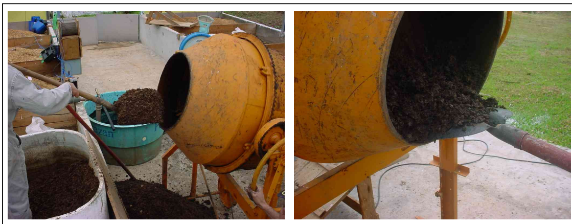
Figura 9 – Utilização de betoneira para mistura e homogeneização dos dejetos no tratamento 2.
