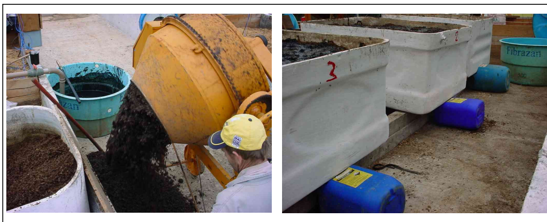
Figura 3 – À esquerda, betoneira utilizada para a mistura dos materiais utilizados no tratamento 2. À direita, caixas de PVC-1000 L utilizadas na 1ª fase experimental e os recipientes de captação de dejetos não absorvidos.
