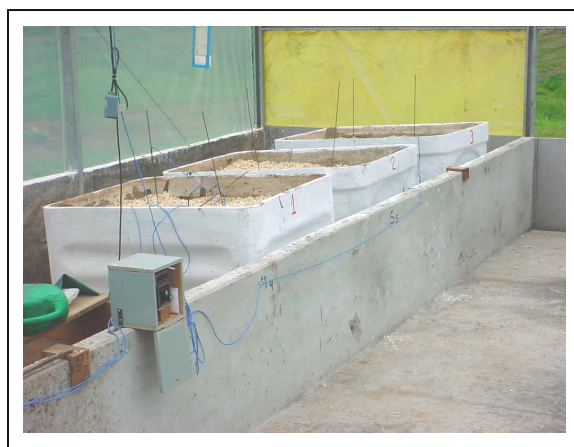
Figura 7 – Caixas de PVC utilizadas durante a 1 o fase experimental (Fase de Impregnação de dejetos).
