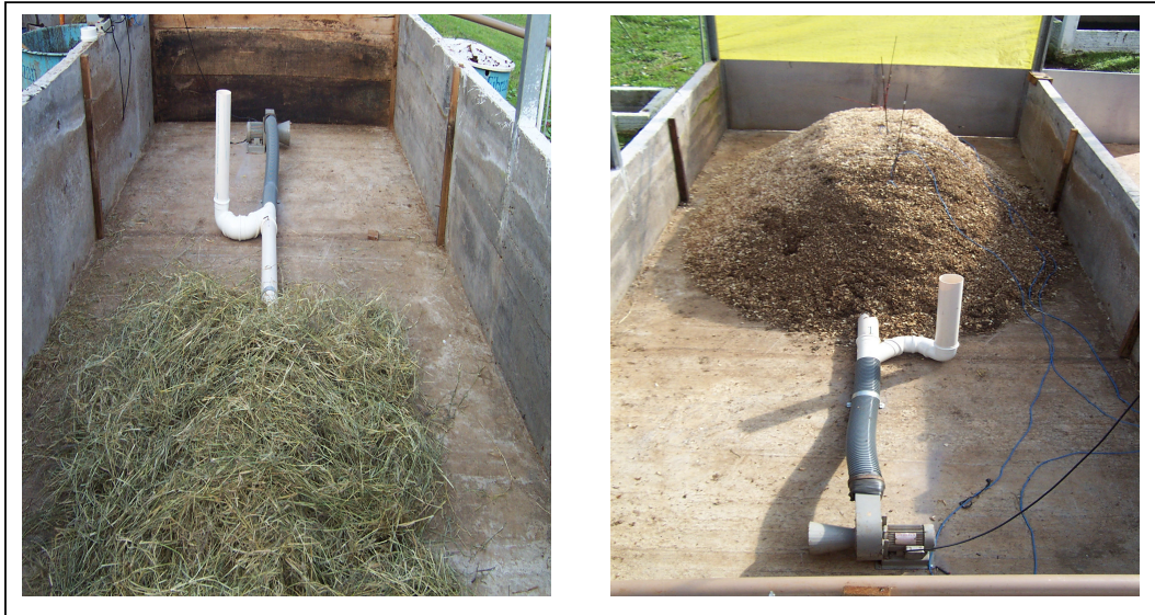
Figura 13 – À esquerda, sistema de aeração ativa ou forçada anteriormente à montagem da pilha B. À direita, pilha B equipada de sistema de aeração ativa ou forçada.
