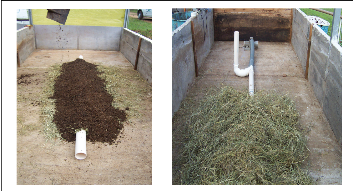
Figura 4 – À esquerda, sistema de aeração passiva (tratamento A da 2ª fase experimental). À direita, sistema de aeração ativa (tratamento B da 2ª fase experimental).
